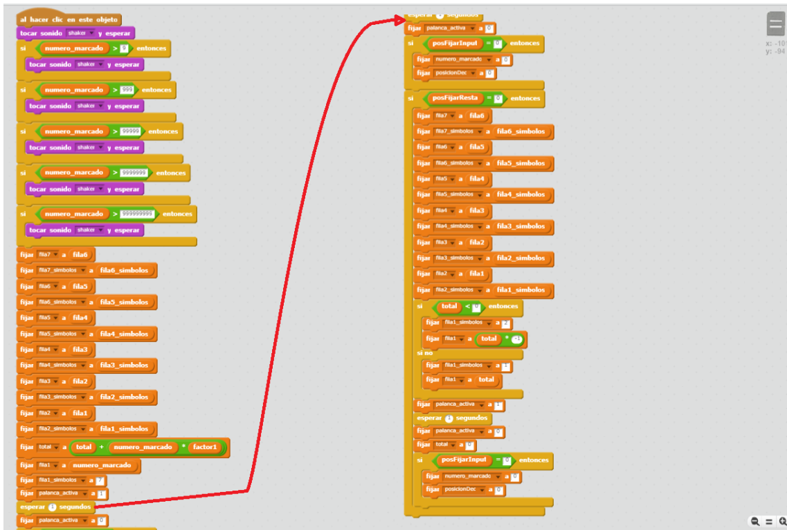
Figura 5.13: Programación del objeto Resolver multiplicación positiva en la simulación de la calculadora Multisumma 20 hecha con Scratch.
