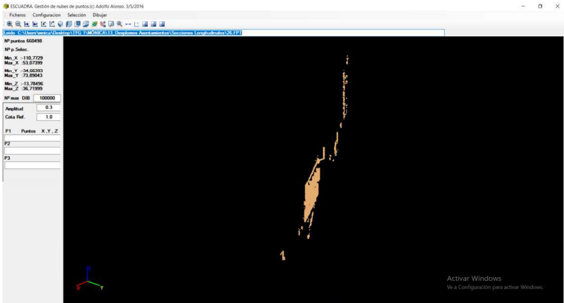
FIG. 27: Sección longitudinal obtenida de la nube de puntos vista en el programa Escuadra
