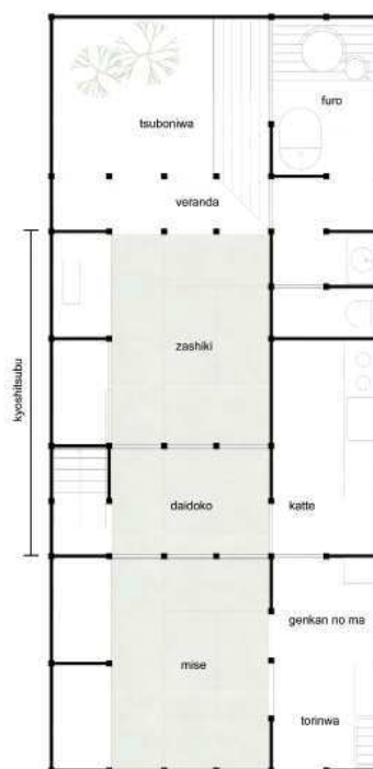
Fig. 14 Figura de autor. Planta tipo de una machiya .
