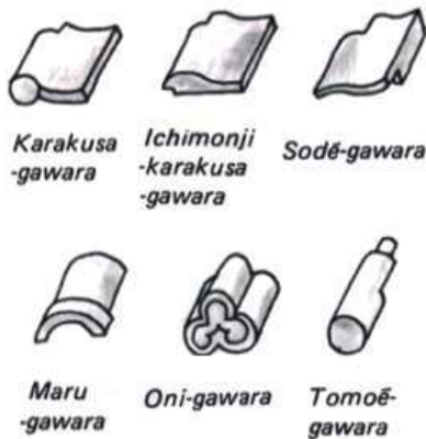
Fig. 56 Tipos de tejas cerámicas (kawara).
