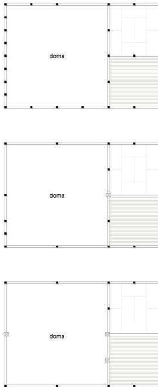
Fig. 6 Figura de autor. Disposición de los pilares en la doma y en sus límites. Daikokubashira .
