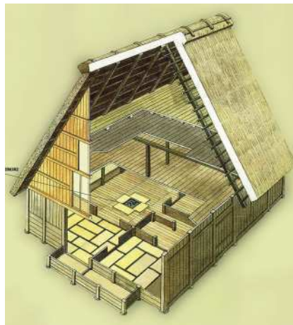
Fig. 8 Distribución tridimensional de una vivienda gassho .
