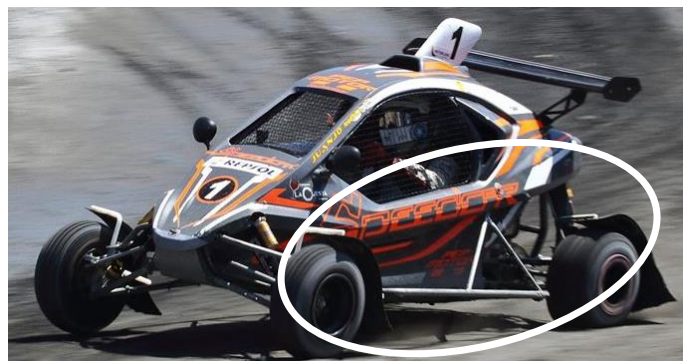
Ilustración III.10. Protección lateral del Car Cross Xtrem
