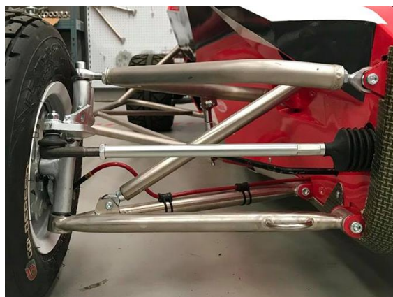
Ilustración I.12. Suspensión delantera del Car Cross de La Base
