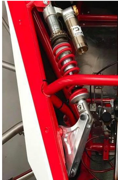
Ilustración I.13. Mecanismo de suspensión delantera del Car Cross de La Base
