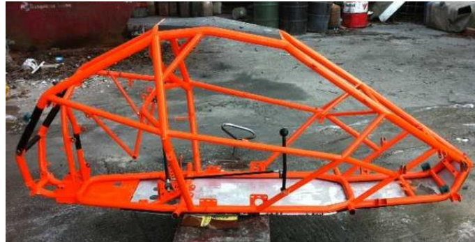
Ilustración I.8. Estructura tubular del Car Cross Speedcar Xtrem
