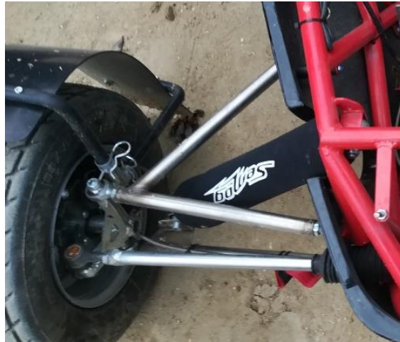
Ilustración I.11. Configuración brazo suspensión delantera
