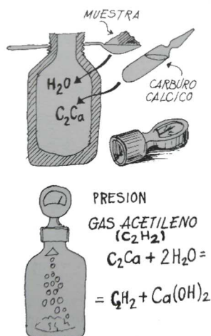
FIGURA 13: Ensayo por gas acetileno. (F. Ortega. 1994)
