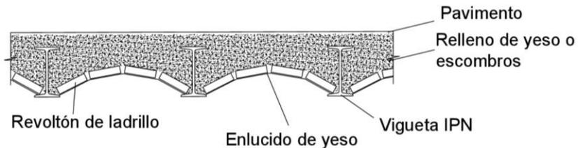
Figura 37. Detalle del Forjado con viguetas metálicas. 2018. Fuente: Propia
