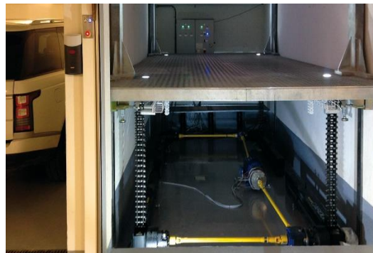
Figura 4. Cardok: Carlift con tecnología de cadena rígida.
