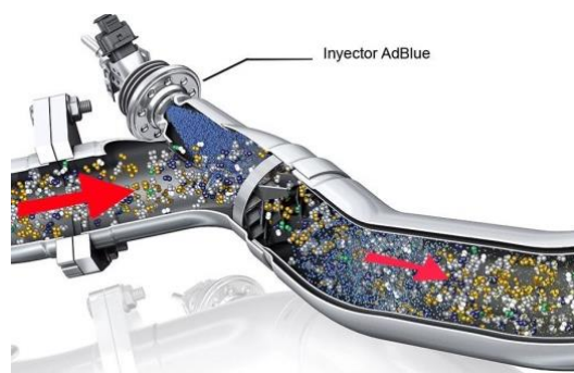
Figura 26. Sistema de inyección de Adblue
