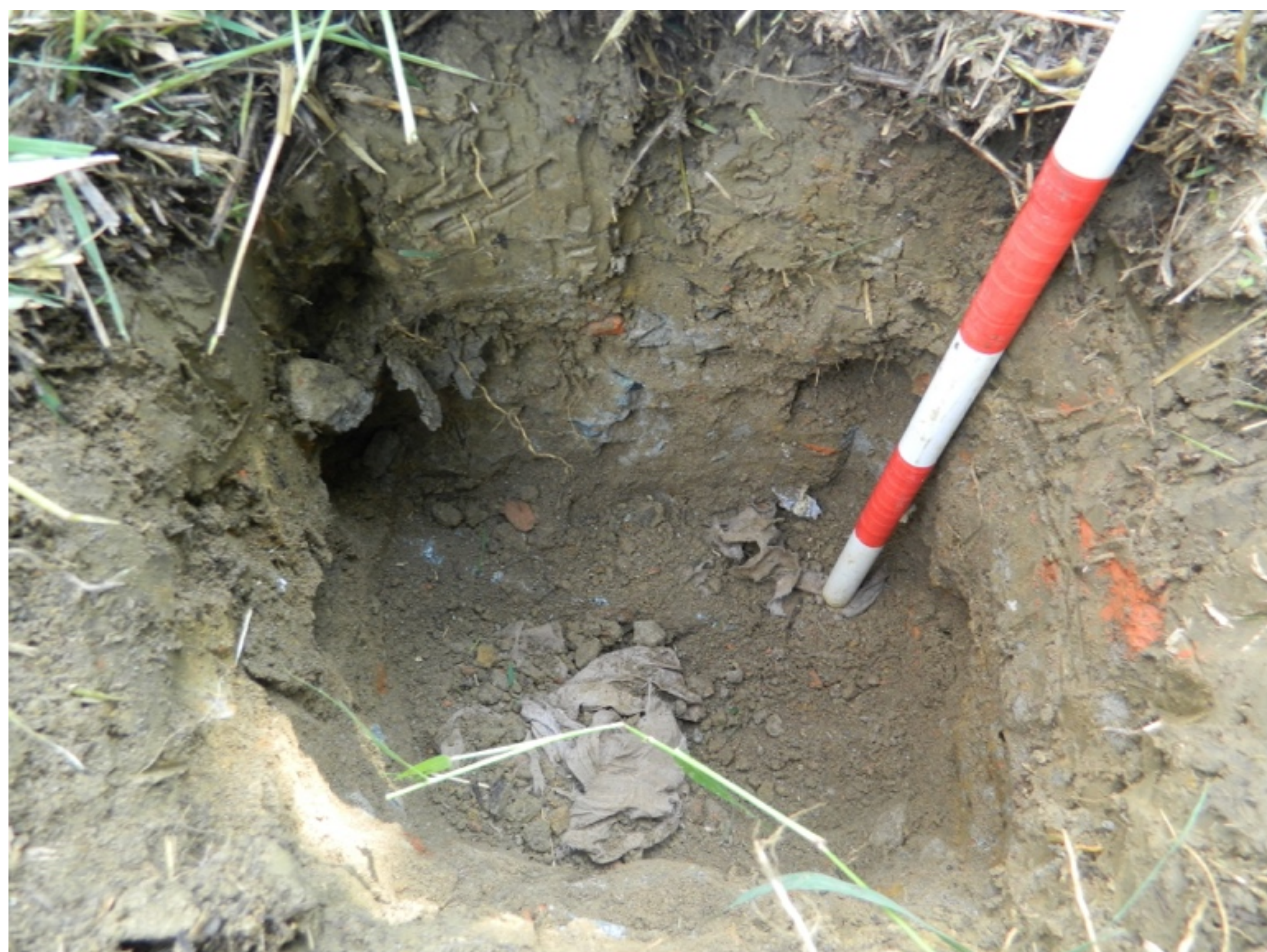
Ilustración 23.. APIQUES REALIZADOS POR SAINC
