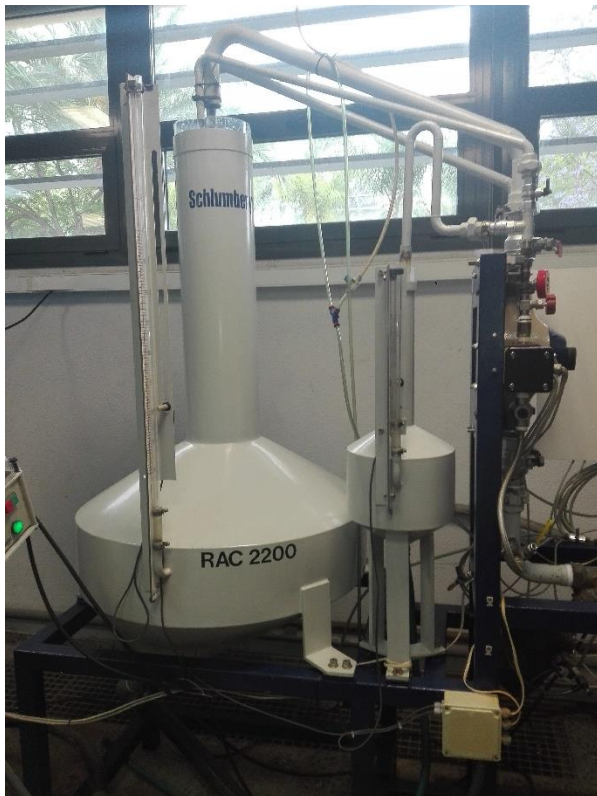
Ilustración 35. Depósitos Schlumberger de 10l (derecha) y 200l (izquierda)
