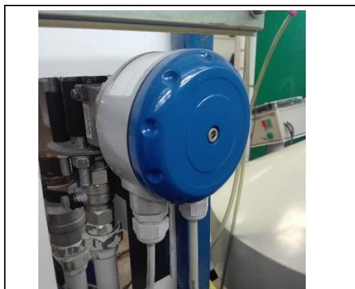
Ilustración 31. Sensor electromagnético de caudal de la marca Krohne (Modelo: OPTIFLUX 1000)
