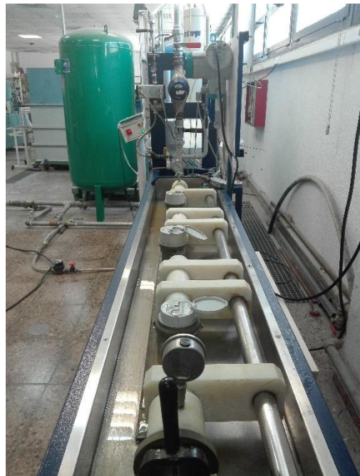
Ilustración 24. Línea de ensayo de contadores montada
