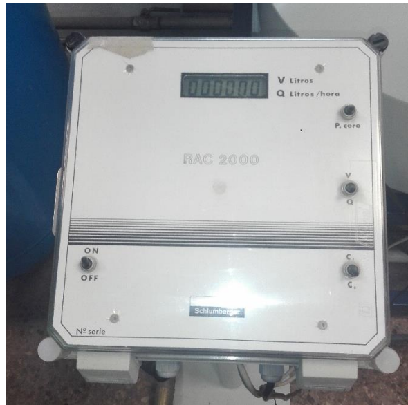
Ilustración 30. Panel de control para ver la medición del caudal que pasa por la línea 3
