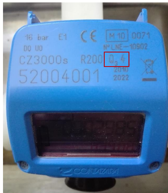
Ilustración 41. Caudal nominal o Q_3 de un contador indicado por el fabricante
