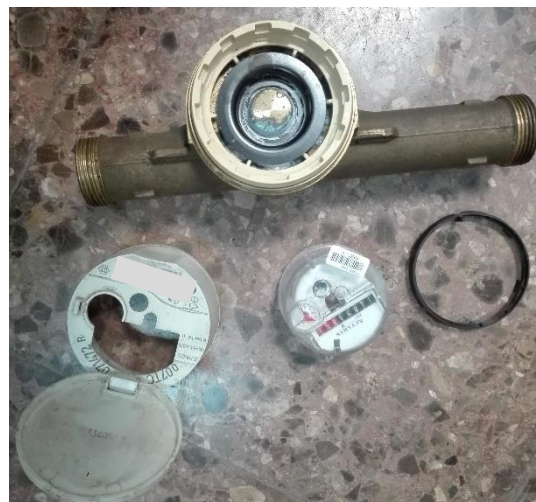
Ilustración 57. Contador con ID 30 desarmado
