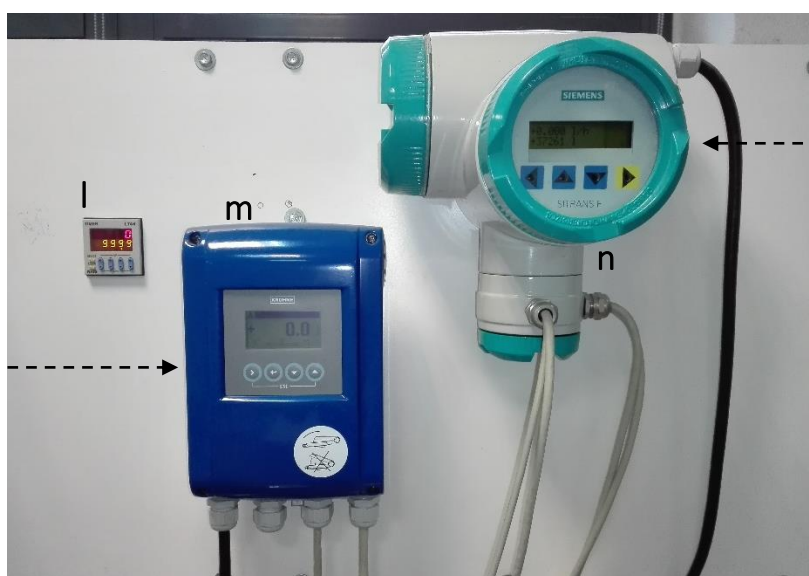
Ilustración 33. temporizador digital Panasonic y caudalímetros electromagnéticos de Krohne (izquierda) y Siemens (derecha)
