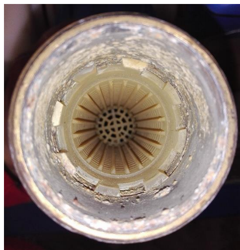
Ilustración 78. Estado del filtro del contador con ID 63
