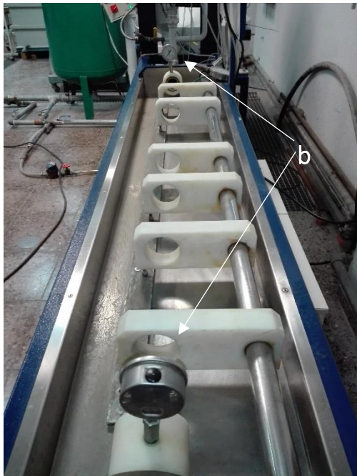
Ilustración 23. Línea de ensayo de contadores desmontada
