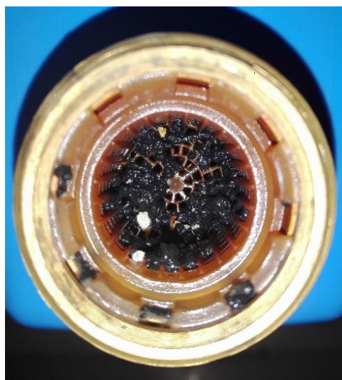
Ilustración 46. Estado del filtro del contador con ID 8
