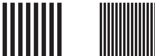
Figura 8.13 Relación entre la cantidad de franjas y la frecuencia de la red.
