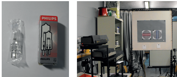
Figura 8.11 Lámpara de proyector Philips de 24V - 150W (izquierda). Disposición del proyector respecto a la dirección de mirada del observador, ángulo de 45^\circ (derecha).
