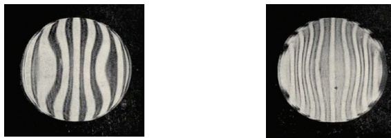
Figura 6.1 Redes con patrón característico de la aberración esférica marginal, adaptado de Ronchi (1962).
