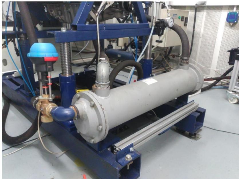
**Imagen 2.6:** intercambiador de calor de carcasa y tubos
