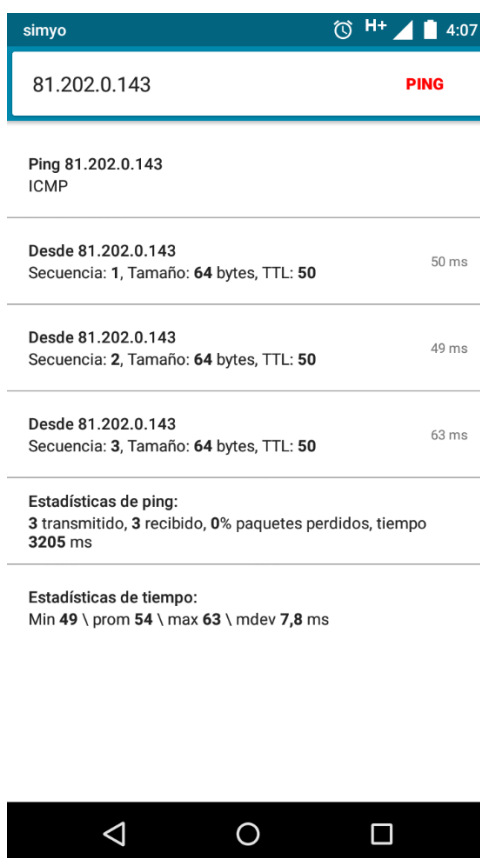
Figura 11.4.2: Tiempos de latencias entre el terminal móvil y el PC
