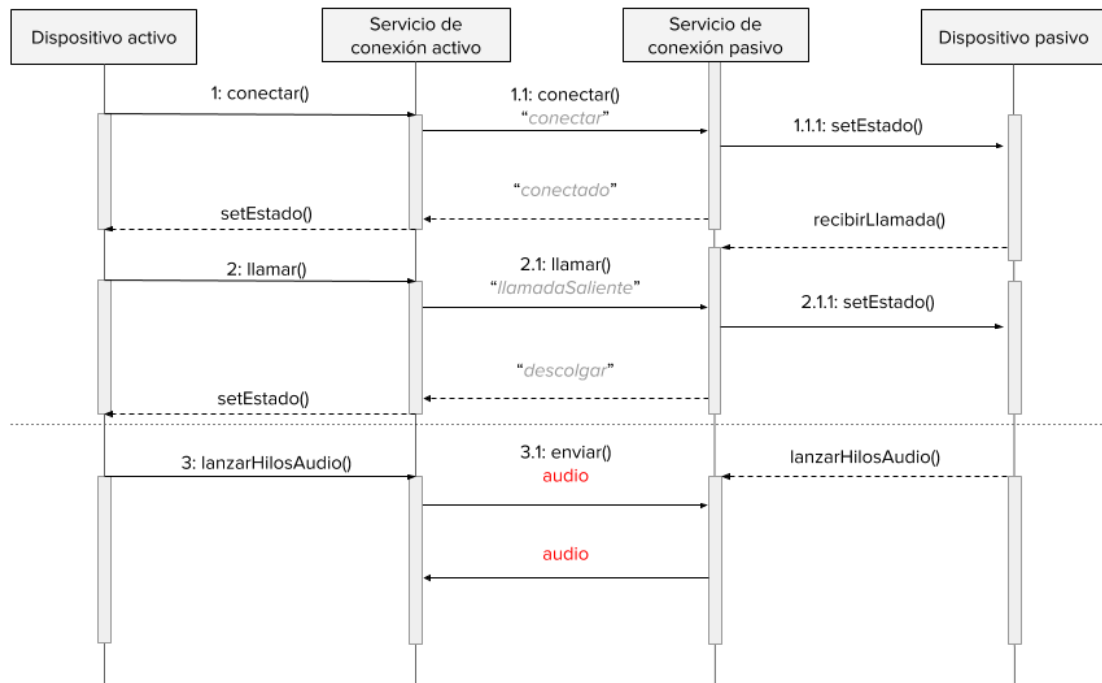
Figura 6.4.1: Protocolo básico de comunicación (descolgar llamada)
