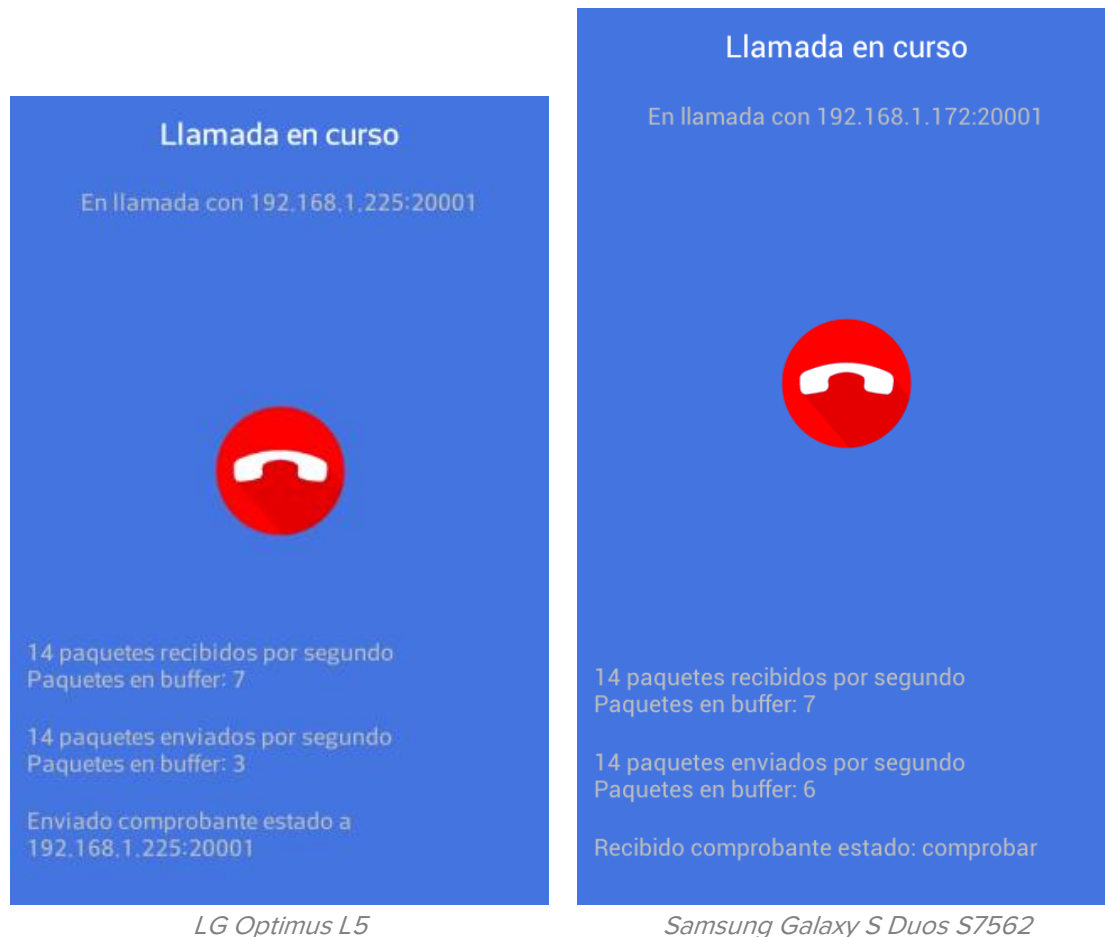
Figura 11.2.1: Dispositivos de la prueba de comunicación de dos terminales móviles
