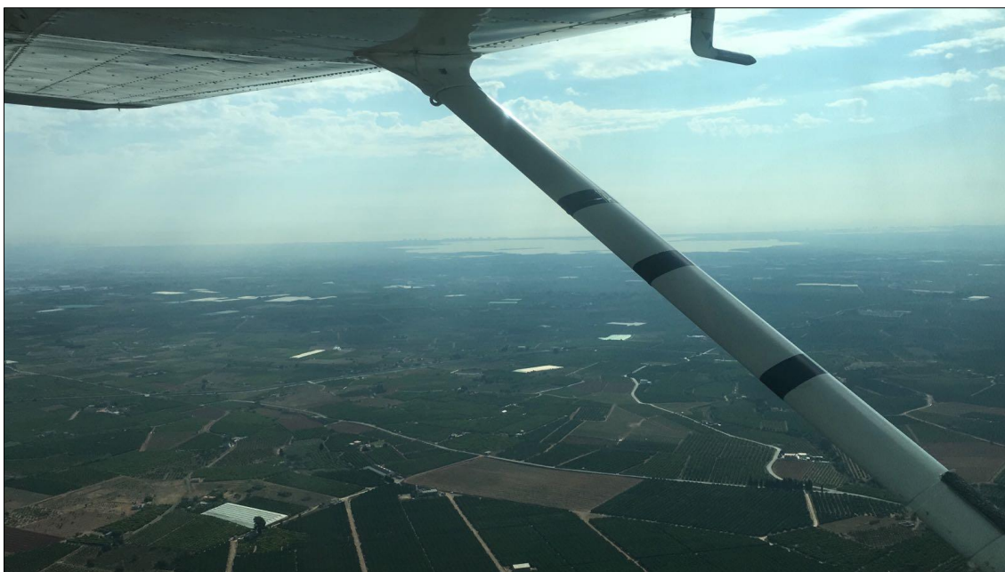
Figura 8. Detalle del ala del avión con subdivisiones para determinar la distancia a la que se realizaban observaciones.
