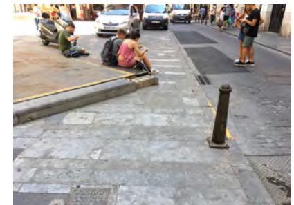
IMAGEN 24. Bolardos utilizados en el tramo analizado con franja de contraste en la parte superior
