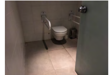
IMAGEN 33. La cabina adaptada no permite el espacio de maniobra mínimo requerido
