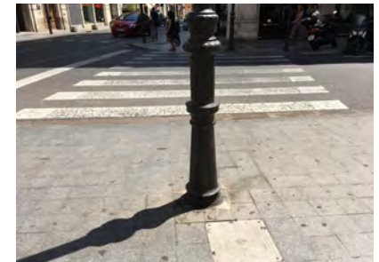
IMAGEN 8. Elementos verticales de iluminación invaden la proyección de cruce del paso de peatones
