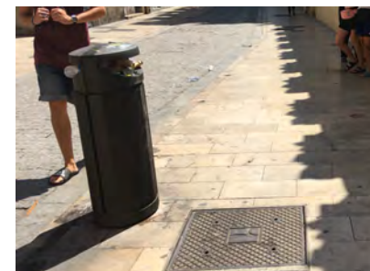
IMAGEN 14. Papelera accesible por la altura de la boca y por su proyección total al suelo
