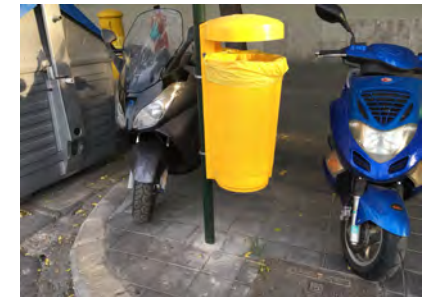
IMAGEN 19. De los distintos modelos de papelera encontrados en el recorrido este no cumple la altura de la boca ni la proyección al suelo
