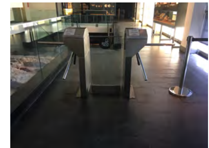
IMAGEN 9. Acceso al museo mediante tornos. A los usuarios de silla de ruedas les deben retirar la cinta de protección para su paso por el lateral
