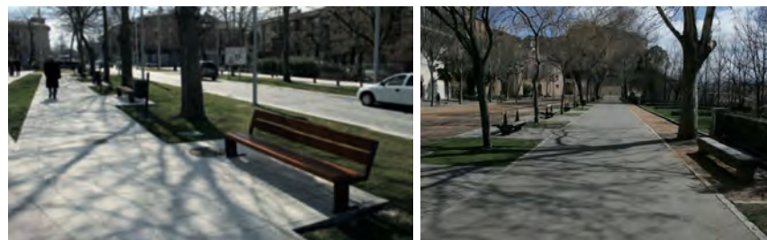
Fig. 75 Alineación del mobiliario y señalización contrastada (FUENTE: FUNDACIÓN ONCE, 2011. Manual de Accesibilidad para Técnicos Municipales . pp.254-355)
