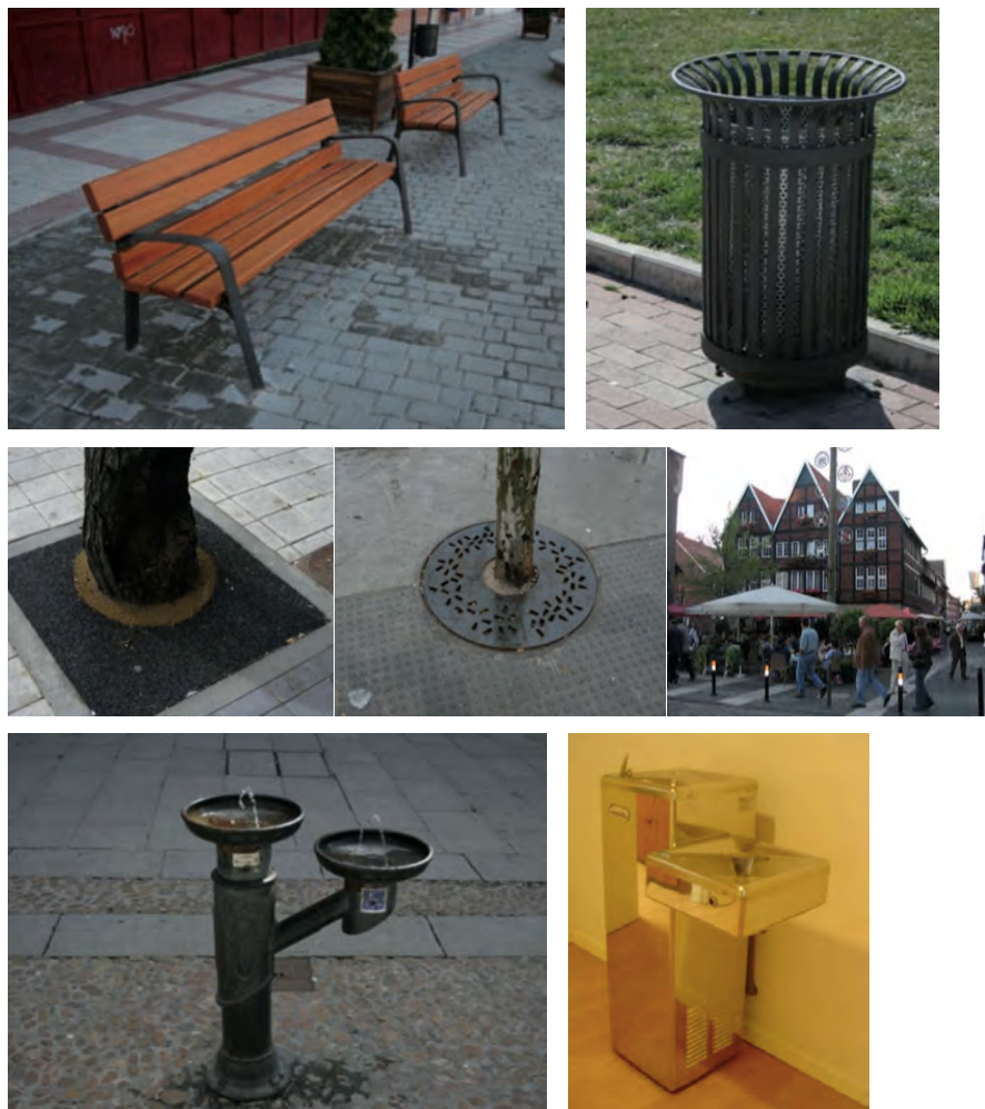
Fig. 77 Composición que ilustra buenas prácticas en el mobiliario: bancos con respaldo y apoyabrazos, papeleras con proyección hasta el suelo, alcorques protegidos, bolardos señalizados y distintas fuentes bebederas a distintos niveles de altura (Fuente: FUNDACIÓN ONCE, 2011. Manual de Accesibilidad para Técnicos Municipales . pp. 127-227-228-229-359-370-374)
