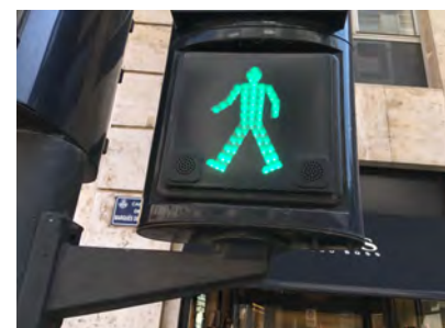
IMAGEN 16. Semáforos dotados con señalización acústica de activación por el usuario
