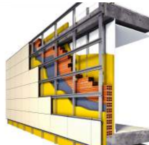
Ejemplo montaje subestructura aplacado
