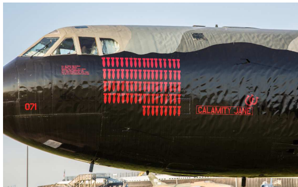
Figura 1.3: Entrada en régimen de postpandeo de una sección del fuselaje del Boeing B-52 [19].
