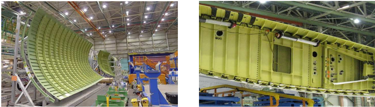
Figura 1.1: Ejemplos de estructuras aeronáuticas. Izquierda: sección de fuselaje aeronáutico [17]. Derecha: cajón de torsión del ala del Boeing 787-9 [18].
