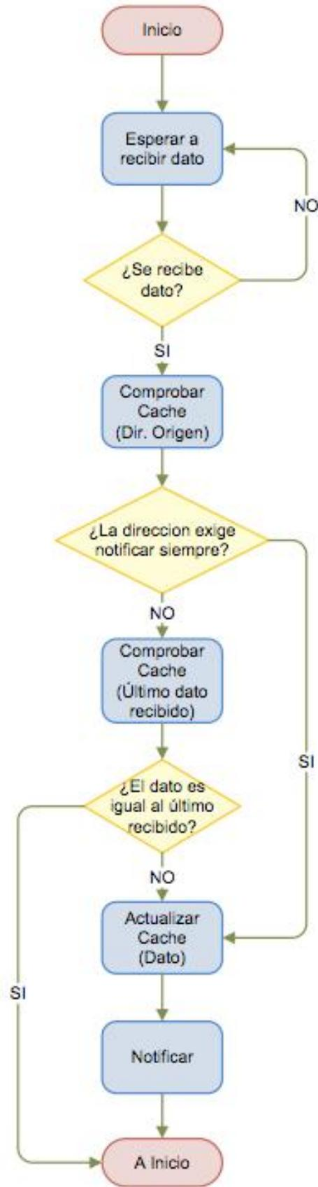
Ilustración 7 – Diagrama de flujo de los sensores
