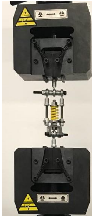
Figura 105. Tensor en la máquina de tracción
