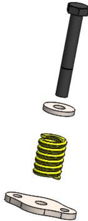
Figura 114: Montaje del conjunto disco de apoyo, plato de compresión, muelle y eje central
