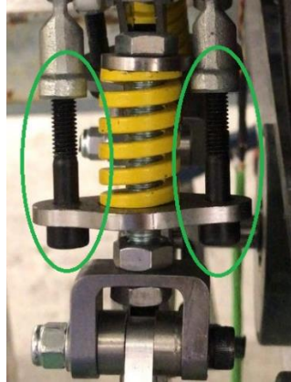
Figura 129: tirantes del tensor a apretar
