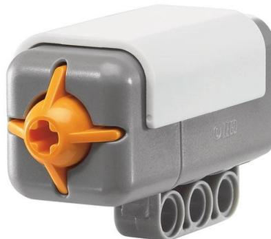
**Figura 33: Sensor de contacto del Legó NXT**
