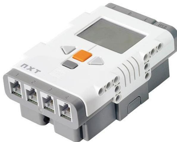
Figura 29: Ladrillo del Lego NXT
