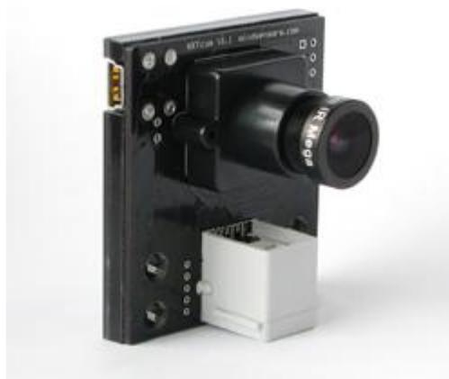
Figura 36: Sensor cámara NXTCam V2
