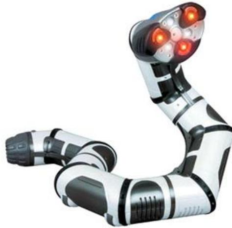
**Figura 19: Robot reptador**
