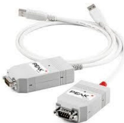
Imagen 13, Dispositivo PCAN-USB que permite interfacear un ordenador con un bus CAN
