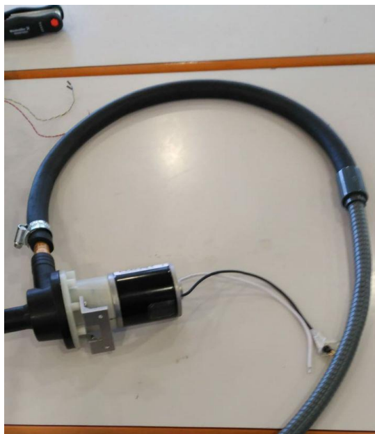
Imagen 18, bomba de refrigerante con el circuito de refrigeración.
