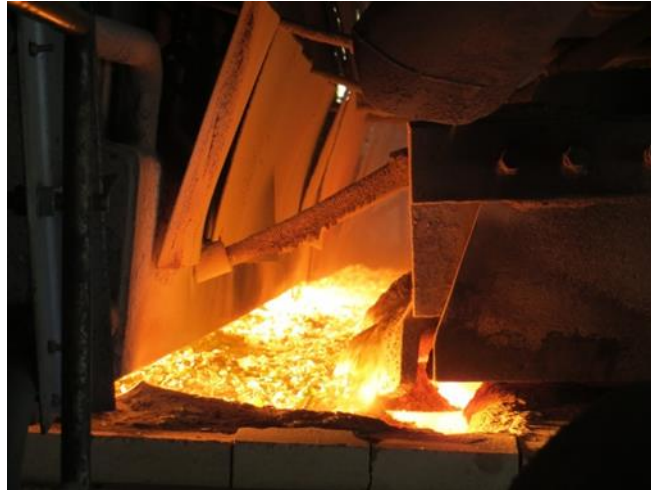
Ilustración 26. Vidrio fundido dentro de horno de fusión.
