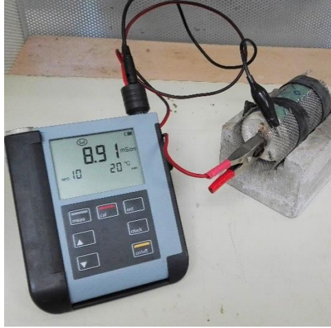
Figura 2.28. Medida de la conductividad entre el electrodo de trabajo (armadura) y el contraelectrodo (malla de acero inoxidable).
