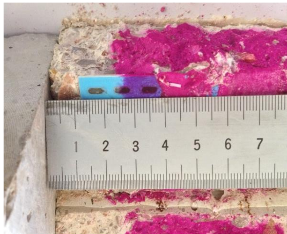
Figura 1.54. Ensayo de fenolftaleína para contrastar la información recogida por el sensor Ru/RuO 2 thick-film desarrollado por Gandía et al. 226
