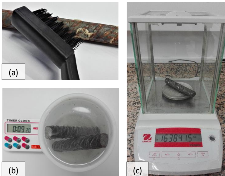
Figura 3.17. Retirada de restos de mortero y óxidos adheridos a las armaduras por medios mecánicos no invasivos (a), ciclos de limpieza química con ácido fosfórico 1 molal (b) y pesado final de las piezas para calcular la pérdida de masa (c).
