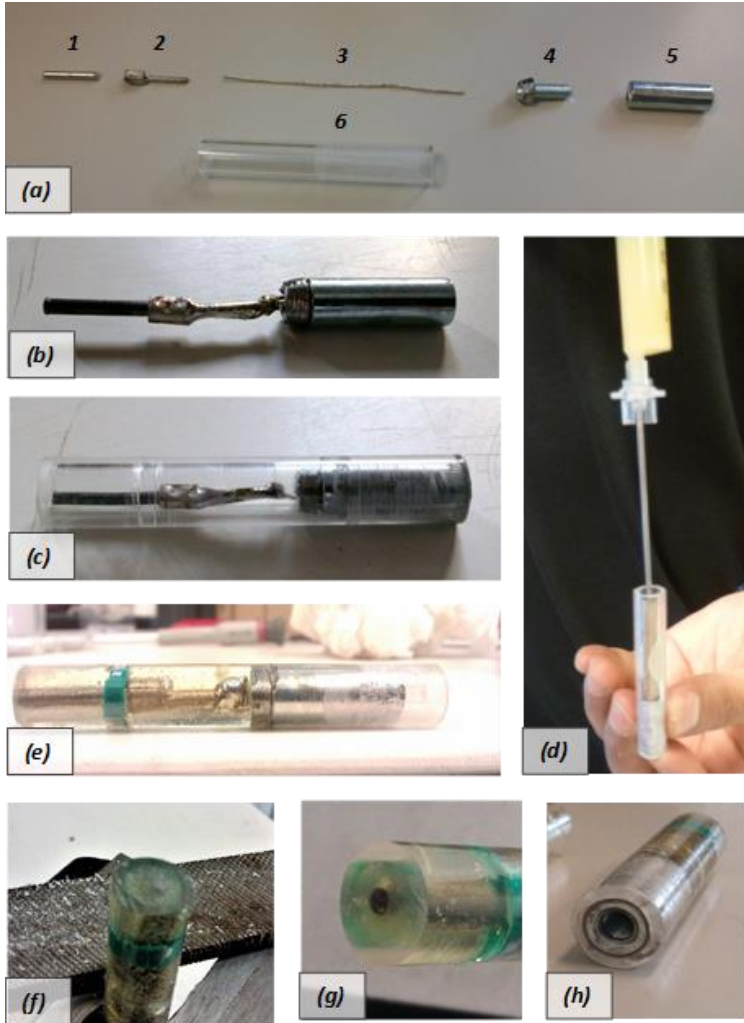
Figura 3.29. Proceso de fabricación del electrodo de hierro no aleado cuyos componentes se muestran en la imagen (a): 1-Barra de Fe 99.95 %; 2-Conector eléctrico; 3-Cable de cobre; 4-Tornillo acero inoxidable; 5-Casquillo roscado de acero inoxidable; y 6-Tubo metacrilato. El resto de imágenes muestran: la barra metálica con el terminal roscado acoplado (b); el electrodo encapsulado en tubo de metacrilato (c); llenado con resina epoxi (d); aspecto del electrodo tras curado en estufa (e); retirada de la resina sobrante hasta alcanzar el extremo de la barra de hierro (f); superficie de trabajo del electrodo (g) y extremo opuesto donde se encuentra el terminal roscado (h).
