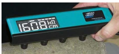
Figura 1.44. Dispositivo Resipod de la empresa Proceq para medir la resistividad del hormigón in situ. 205
