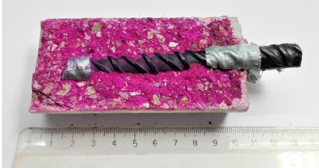
Figura 3.22. Ensayo de fenolftaleína a los 48 meses sobre una probeta del grupo C.
