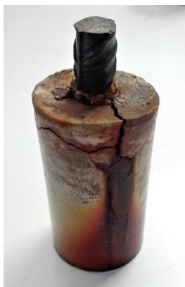
Figura 4.14. Estado de una de las últimas probetas que permaneció conectada a la macrocelda de corrosión.
