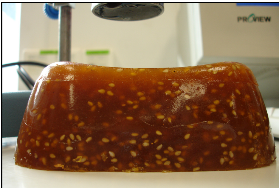
Figura 5.5: Phantom con dispersores de sésamo y fibras mucilaginosas.
