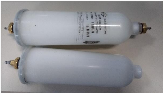
Figura 5. Dos filtros HEPA PALL PN12144.
