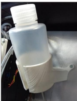
Figura 10. Tanque externo de alcohol isopropílico.
