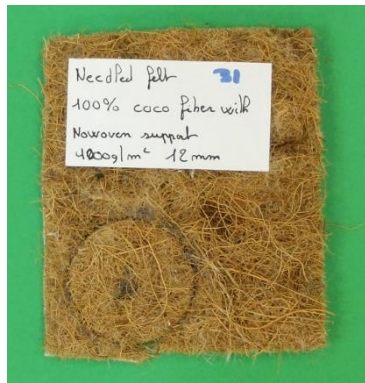
Figura 2. 7 Coco, espesor de 1.2 cm
