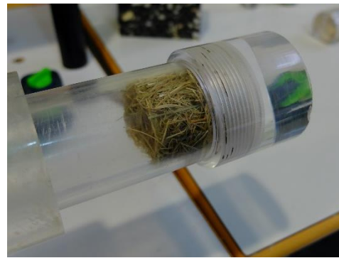
Figura 2. 27 Muestra final colocada para la medición del coeficiente de absorción acústica
