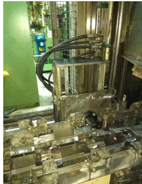
*Ilustración 2. Sistema de movimiento del calibre de medición y lavadora transfer, izquierda y derecha respectivamente.*
