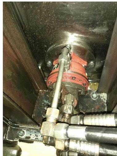
Ilustración 57. Componentes hidráulicos, motor y freno.
