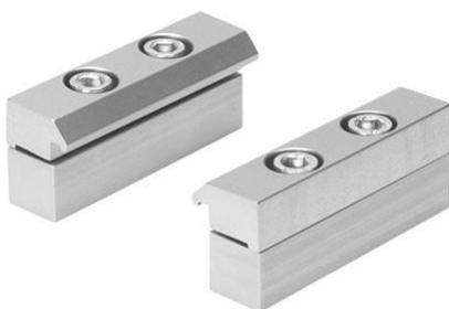
La brida de sujeción permite instalar el conjunto de cilindro y servo de manera vertical posicionándolo en el soporte requerido. estas se atornillas a la superficie del elemento de sujeción y por medio de presión entre las dos placas que dispone, aprisionan el cuerpo del cilindro para trabajar en una posición, en este caso vertical.
