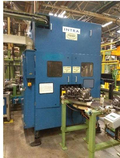
*Ilustración 19. Calibre automático de medición.*
