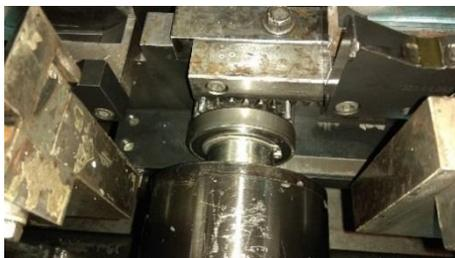
Ilustración 59. Detalle del sistema piñón-cremallera.
