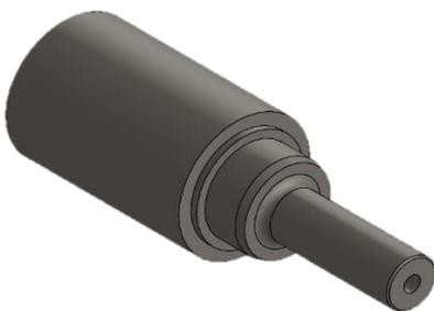
Ilustración 66. Diseño 3D del eje de transmisión de la caja de rodamientos.
