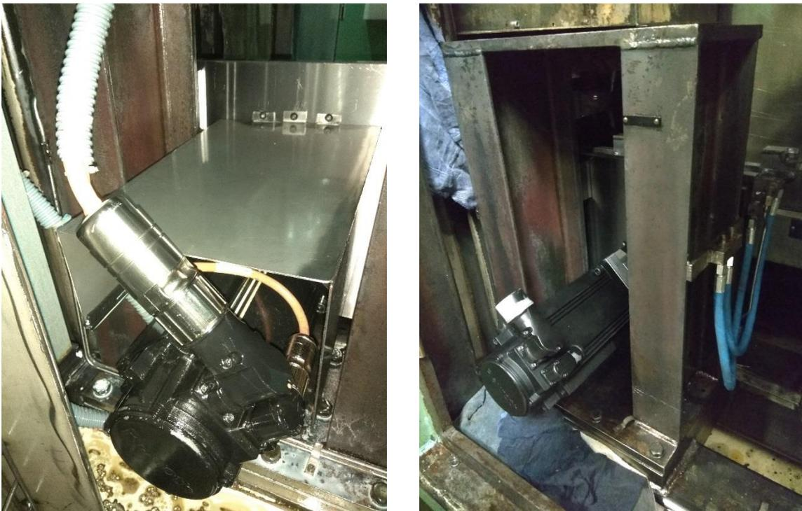
*Ilustración 68. Instalación del servo en máquina.*
