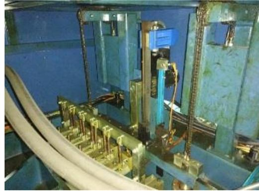
Ilustración 20. Sistema de movimiento del calibre de medición.
