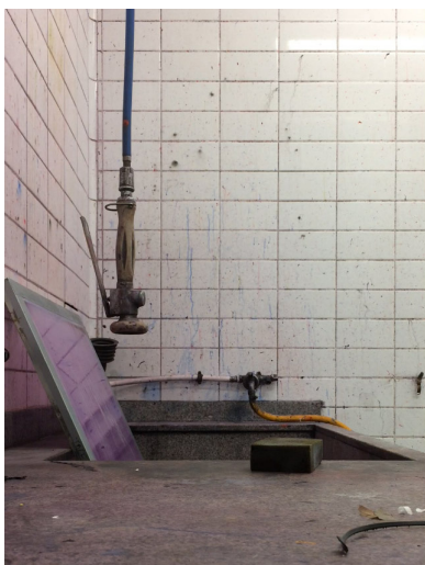
26. Lavar para eliminar restos de emulsión.
