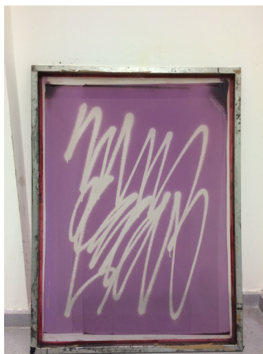
27. Obtención de la imagen en la pantalla.
