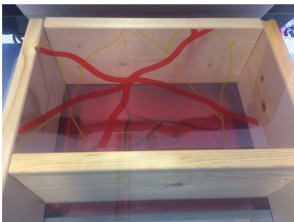
36. Estructura de madera sobre el escáner para disponer los acetatos a distintas alturas.
