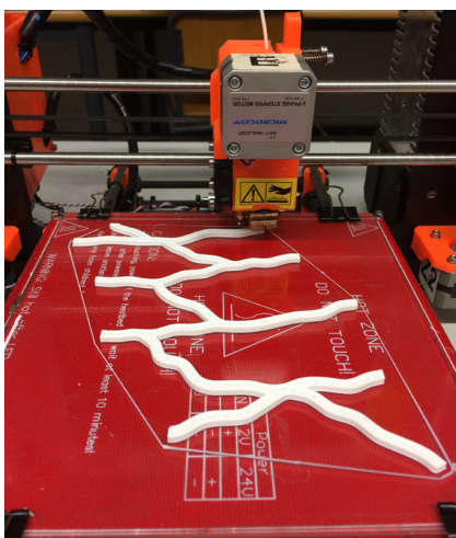
12. Impresora 3D PRUSA. Proceso de impresión con PLA plástico. LRM, Facultad de Bellas Artes San Carlos de Valencia.
