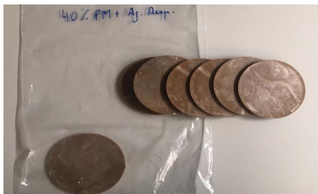
Figura 9. Composite en matriz de polipropileno con fibras lignocelulosas de podadura de árbol de naranja, con respuesta de pasta mecánica al 40% con refuerzo por agente de acoplamiento: 40%PM+Ag.Acop. Fotografía por: Nicole Guzmán Quintero. (Julio, 2018)
