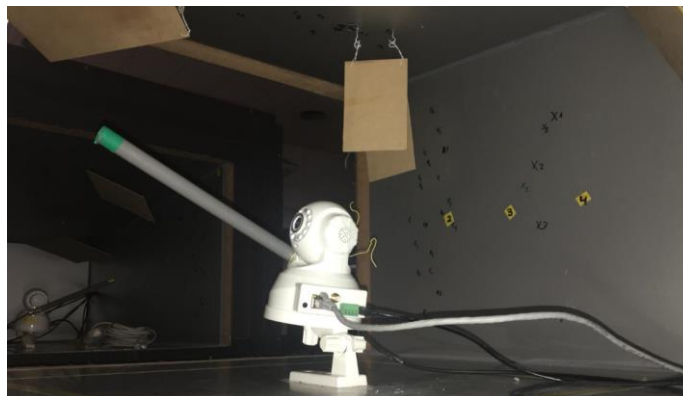
Figura 17. Cámara instalada internamente en la cámara de transmisión para control remoto del posicionamiento de puntos de medida. Fotografía por: Nicole Guzmán Quintero. (Septiembre, 2018)
