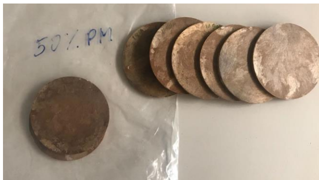
Figura 10. Composite en matriz de polipropileno con fibras lignocelulosas de podadura de árbol de naranja, con respuesta de pasta mecánica al 50%: 50%PM. Fotografía por: Nicole Guzmán Quintero. (Julio, 2018)
