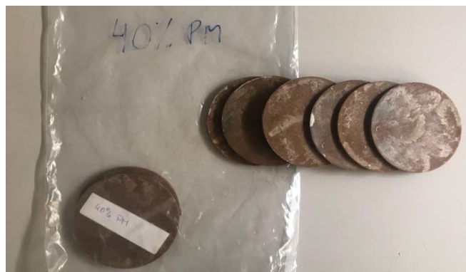
Figura 8. Composite en matriz de polipropileno con fibras lignocelulosas de podadura de árbol de naranja, con respuesta de pasta mecánica al 40%: 40%PM. Fotografía por: Nicole Guzmán Quintero. (Julio, 2018)
