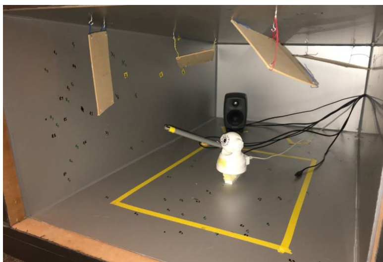
Figura 16. Visualización interna del sistema de control remoto con cámara IP en el recinto receptor de la cámara de transmisión de la EPSG. Fotografía por: Nicole Guzmán Quintero. (Julio, 2018)
