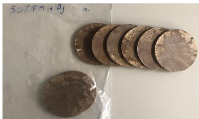
Figura 11. Composite en matriz de polipropileno con fibras lignocelulosas de podadura de árbol de naranja, con respuesta de pasta mecánica al 40% con refuerzo por agente de acoplamiento: 40%PM+Ag.Acop. Fotografía por: Nicole Guzmán Quintero. (Julio, 2018)
