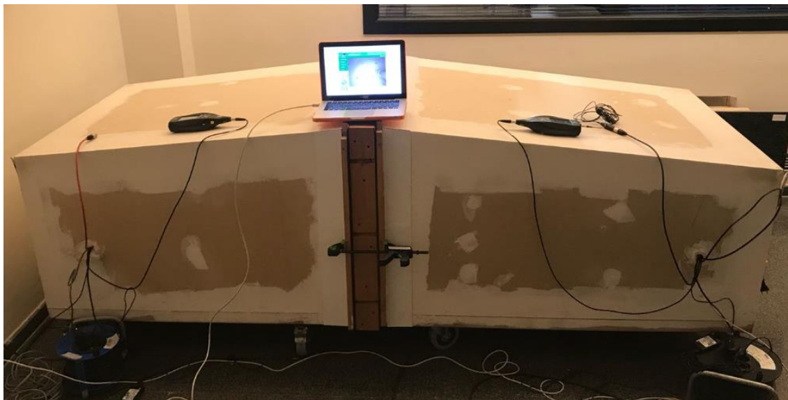
Figura 5. Cámara de transmisión a escala de la Escuela Politécnica Superior de Gandía (UPV) sellada. Sistema de recinto receptor-probeta-recinto emisor cerrado. Fotografía por: Nicole Guzmán Quintero. (Julio, 2018)
