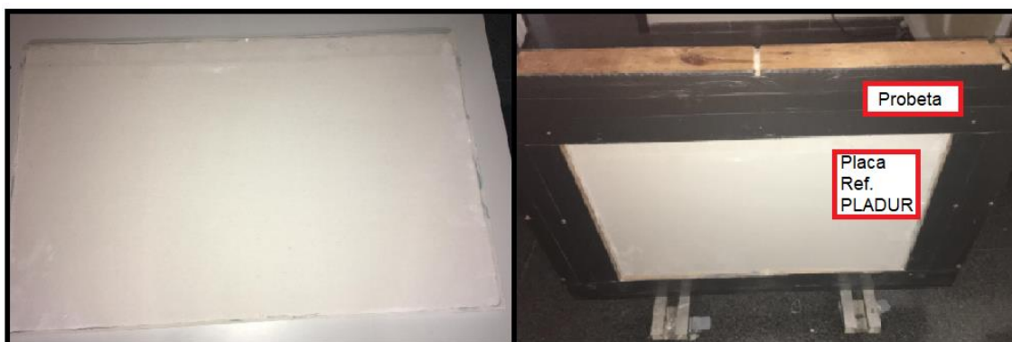
Figura 29. Caracterización placa de cartón yeso. Producto industrializado PLADUR@N13. Fotografía por: Nicole Guzmán Quintero. (Septiembre, 2018)
