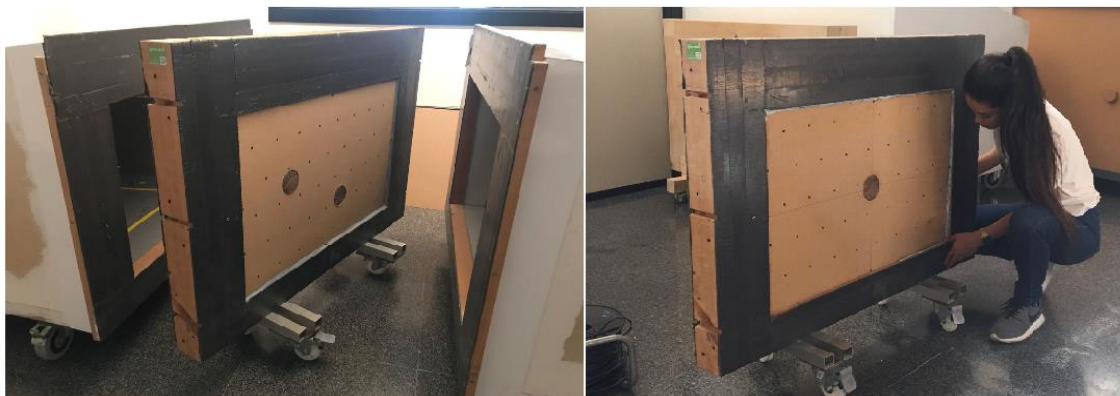
Figura 6. Probeta: Área destinada para instalación de superficies a evaluar en transmisión sonora en la Cámara de transmisión de la EPSG. Fotografía por: Nicole Guzmán Quintero. (Julio, 2018)
