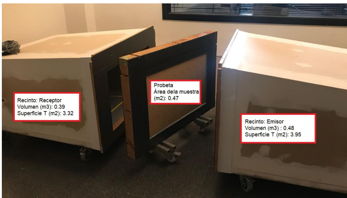
Figura 7. Identificación de espacios en Cámara de transmisión a escala de la EPSG. Fotografía por: Nicole Guzmán Quintero. (Julio, 2018)
