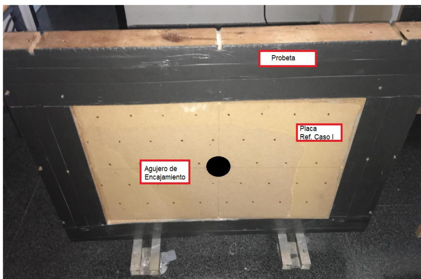
Figura 23. Encajamiento del 5% de composite en material de referencia para instalar en cámara de transmisión a escala. Fotografía por: Nicole Guzmán Quintero. (Septiembre, 2018)
