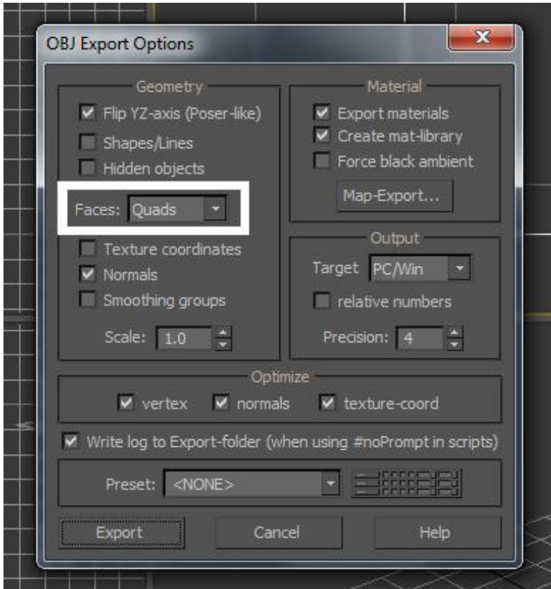
Fig. 33: Imagen del exportador de OBJ's incluido en 3DSMAX, donde se especifica que el *.obj creado esté formado únicamente por quads .
