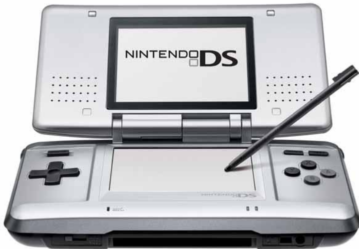
Fig. 2: En un extremo está situado el pad direccional, en el lado contrario se sitúan cuatro botones que se corresponden con el estándar marcado por los modelos de sobremesa como SuperNintendo : X , Y , B y A , incluyendo también los botones SELECT y START (Imagen obtenida de http://zephirothspals.blogspot.com ).
