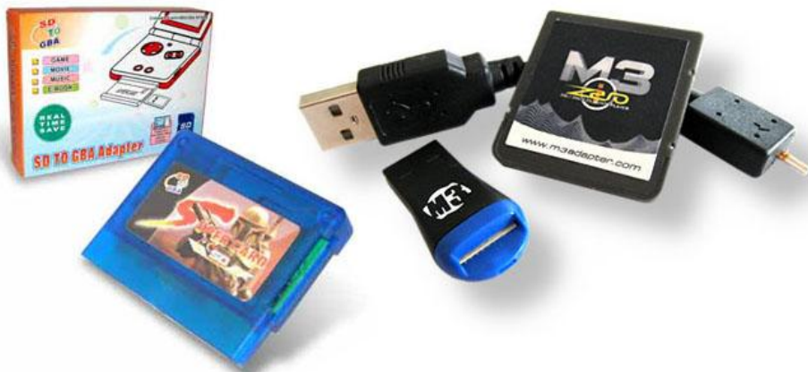
Fig. 10: Las dos flashcarts utilizadas a lo largo del presente proyecto: SupercardSD , de tipo SLOT-2 y M3iZero , de tipo SLOT-1 (Imágenes obtenidas de http://images.discoazul.com/ y http://www.dsiconsolas.com ).
