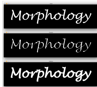
Figura 2.19: Operaciones de Erosión y Dilatación
