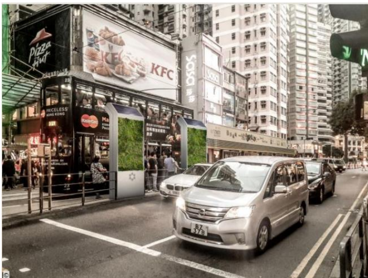
Figura 20. El elemento urbano Citytree utiliza el musgo en su configuración como filtro de aire.
