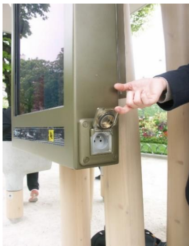
Figura 154. Conexión para cargar dispositivos electrónicos. Fuente: https://blog.ensci.com/smartcitydisplay/sproject/2012/04/17/concept-abribus-comparaison-escalé-numérique/ [Consultado el 15-01-2018]
