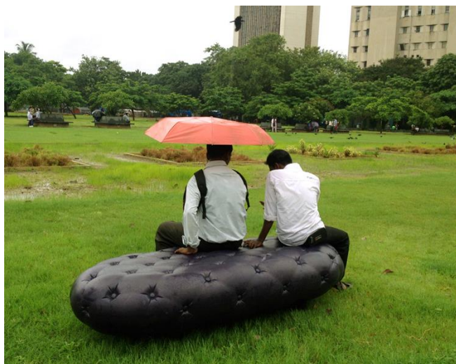
Figura 19. Elemento urbano Water bench, que absorbe el agua lluvia y lo almacena para riego futuro de áreas verdes.
