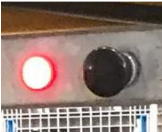
Figura 25. Pick to light con indicador luminoso y pulsador independientes.
