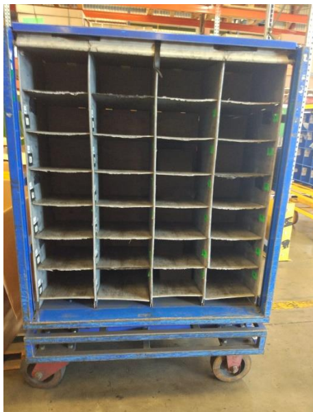
Figura 9. Carro de secuenciación de TRIM A. Cara frontal. Esta cara y su respectiva posterior son similares.
