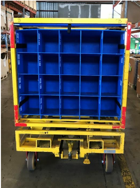
Figura 11. Carro de secuenciación de TRIM B. Cara frontal. Esta cara y su respectiva posterior son similares.
