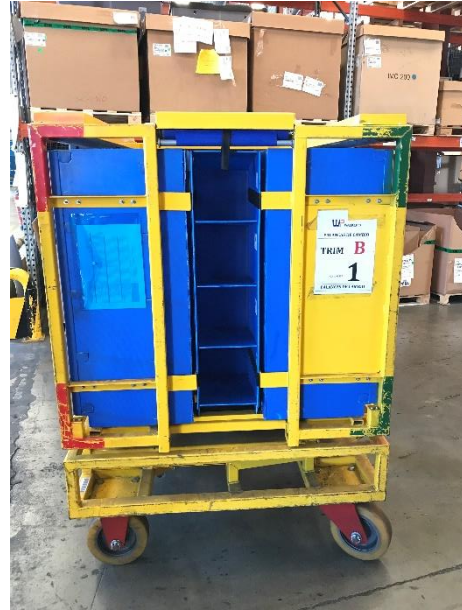
Figura 12. Carro de secuenciación de TRIM B. Cara lateral. Esta cara y su respectiva posterior son similares.
