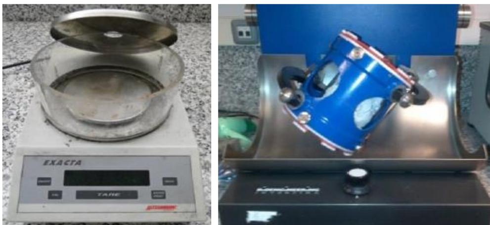
**Ilustración 7:** Izquierda: Balanza Digital. Derecha: Túrbula Bioengineering Inversina
