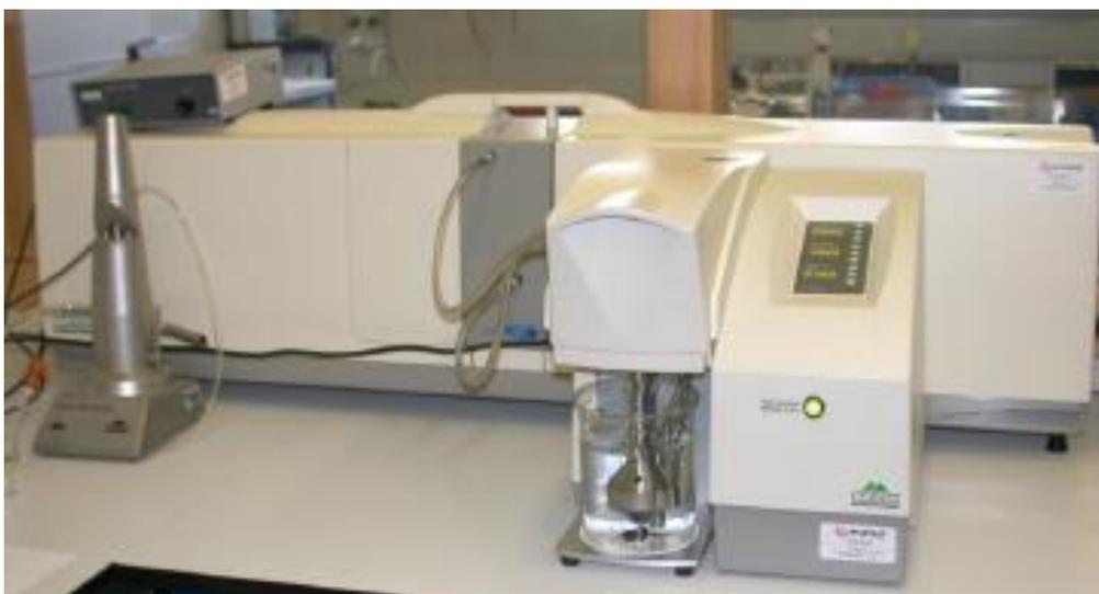
**Ilustración 5:** Difractómetro láser Malvem, modelo Mastersizer 2000
