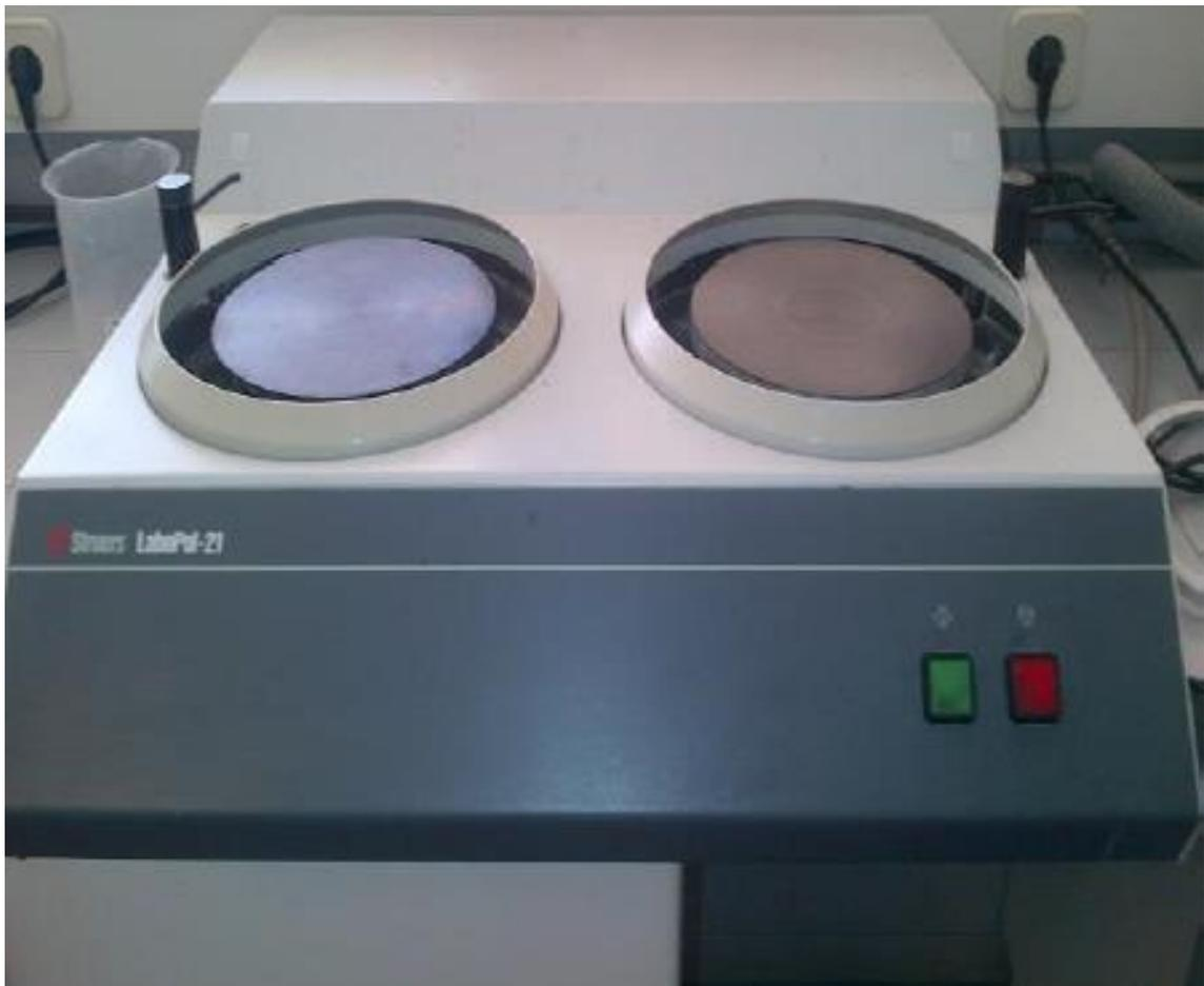
**Ilustración 19:** Desbastadora de dos discos Struers Labopol-21.
