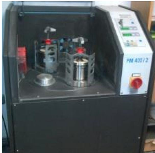
**Ilustración 8:** Molino de bolas planetario modelo PM400/2
