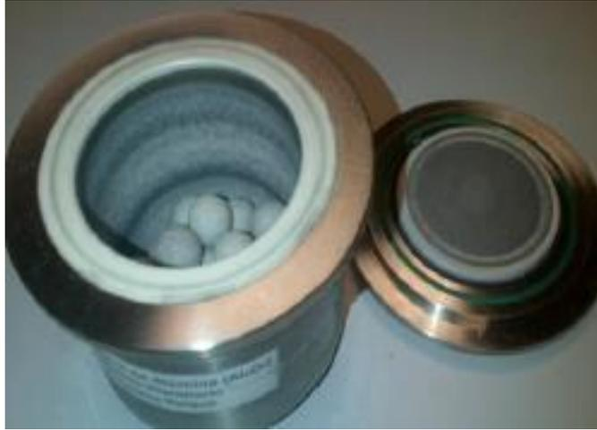
**Ilustración 9:** Jarra y bolas de alúmina utilizadas.
