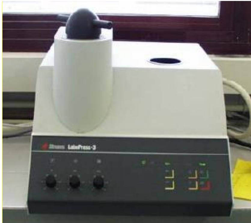
**Ilustración 18:** Embutidora Struers Labopress.3.
