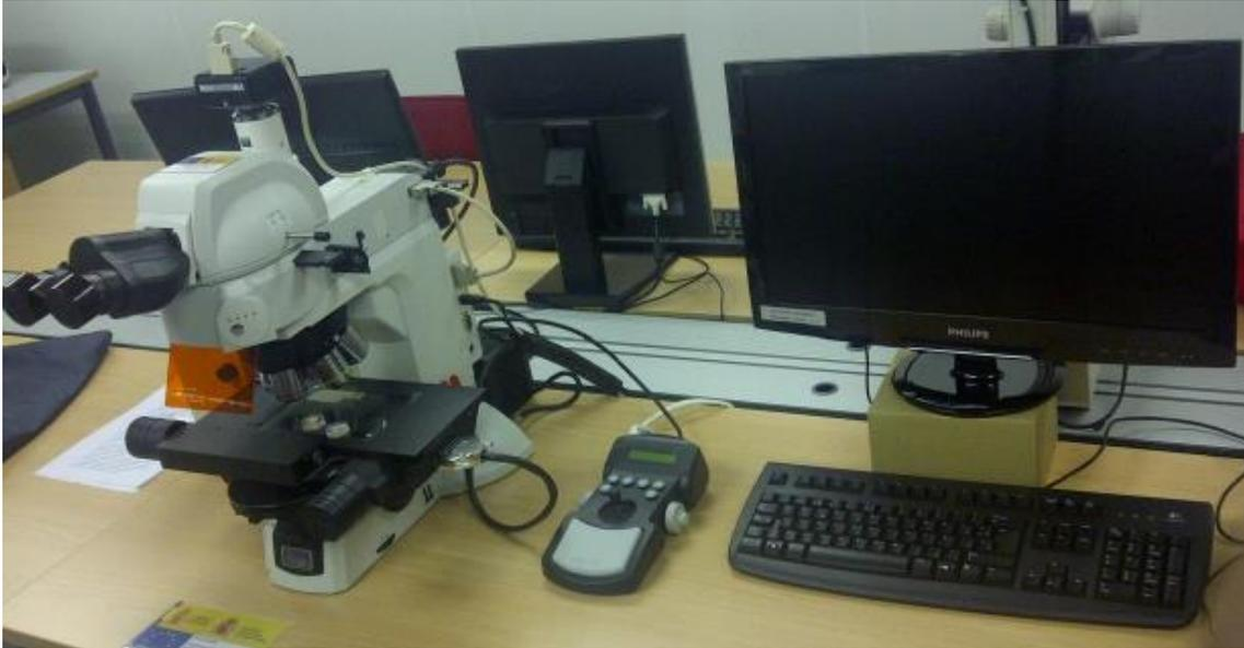
**Ilustración 21:** Microscopio óptico de mesa electrónica y cambio de lente automático Nikon LV-100
