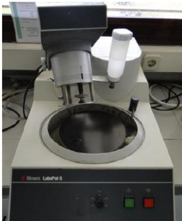
**Ilustración 20:** Pulidora automática Struers Labopol-5.
