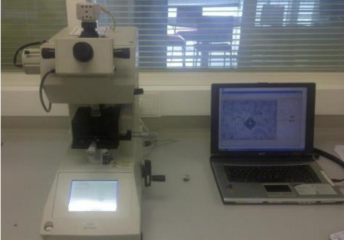
**Ilustración 26:** Microdurómetro automático Shimadzu HMV-2.
