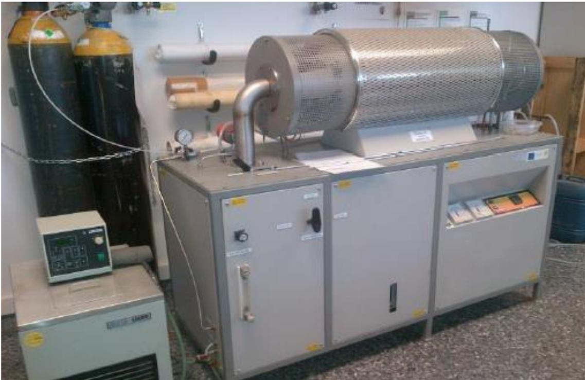
**Ilustración 12:** Horno de vacío Carbolite modelo HVT 15/75/450
