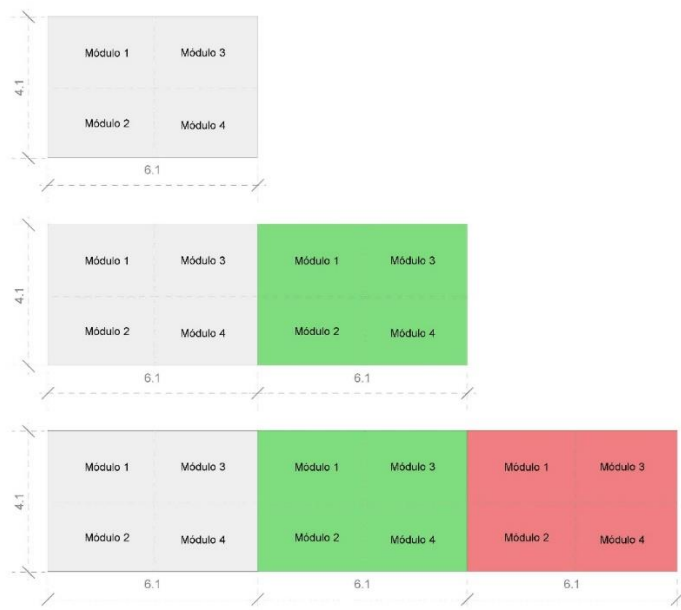
Ilustración 58.- Forma y dimensiones de los módulos base para el prototipo de hospital de campaña para la Zona 6- Ecuador.
