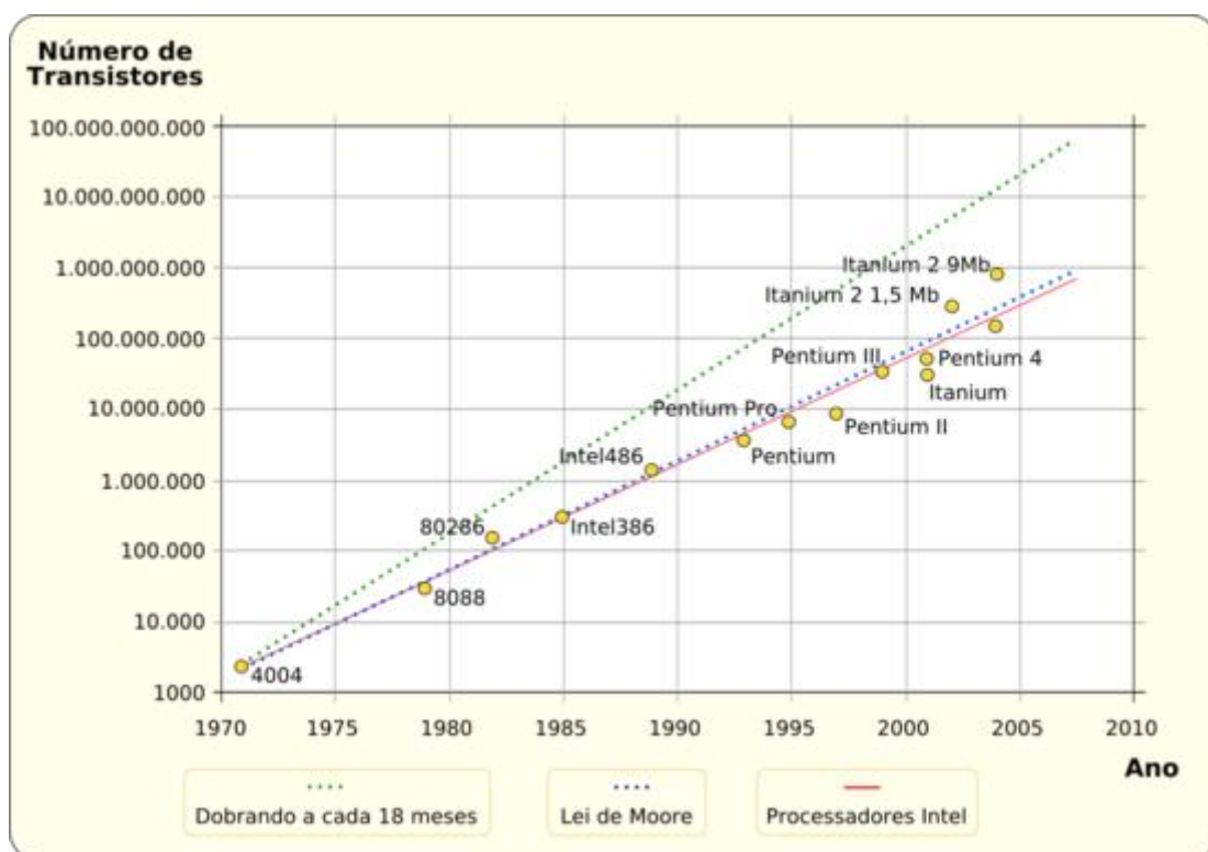
Figura 20. Gráfico lineal acerca de la evolución de los transistores desde 1970 a 2010. Fuente: http://seofilo.com/
