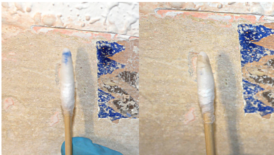
Figura 64. Prueba solubilidad preconsolidación silicato de etilo.
