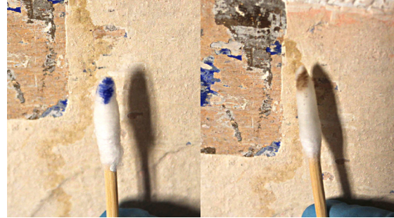
Figura 63. Prueba solubilidad preconsolidación hidróxido bario.
