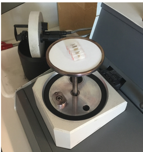
Figura 44. Pulverización catódica en cámara de bajo vacío.
