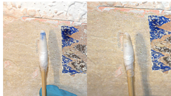
Figura 71. Prueba solubilidad preconsolidación silicato de etilo..
