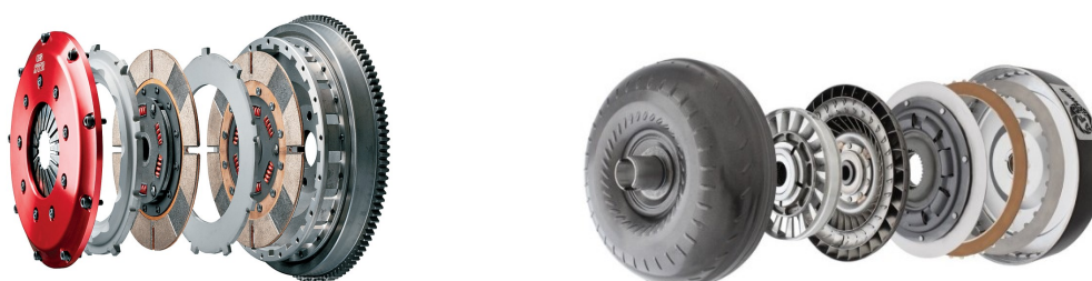
Il·lustració 12. Embragatge de disc sec (esquerra) front al convertidor de parell (dreta)
