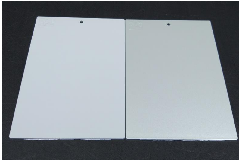
Fig. 30. La plaqueta de la izquierda únicamente cuenta con la aplicación de la imprimación. La plaqueta de la derecha además lleva aplicada la base con el efecto perlado.
