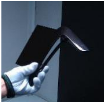
Fig. 25. Medición a visual de un Fender de Ford respecto a patrón.
