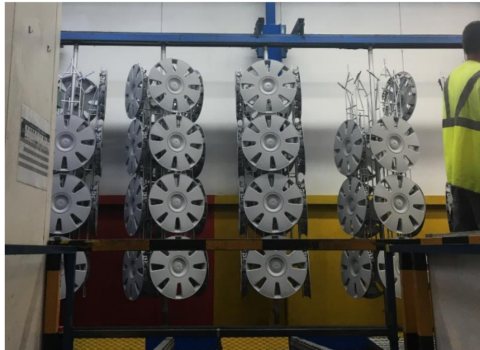
Fig 4. Imagen de un útil cargado con piezas de tapacubos (16 pzs/útil).
