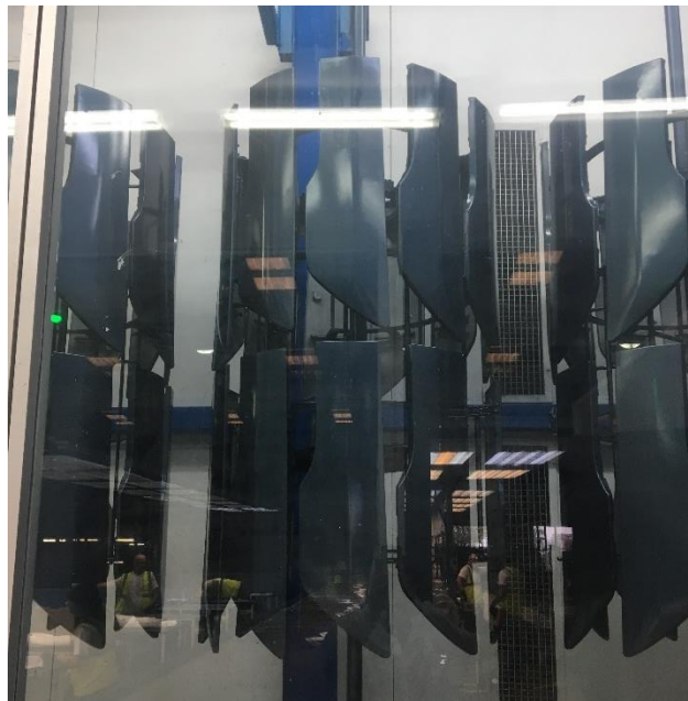
Fig. 5. Imagen de un útil cargado con piezas de molduras (18 pzs/útil).
