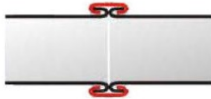
Ilustración 24. Unión por junta transversal con vaina deslizante de tipo bayoneta.
