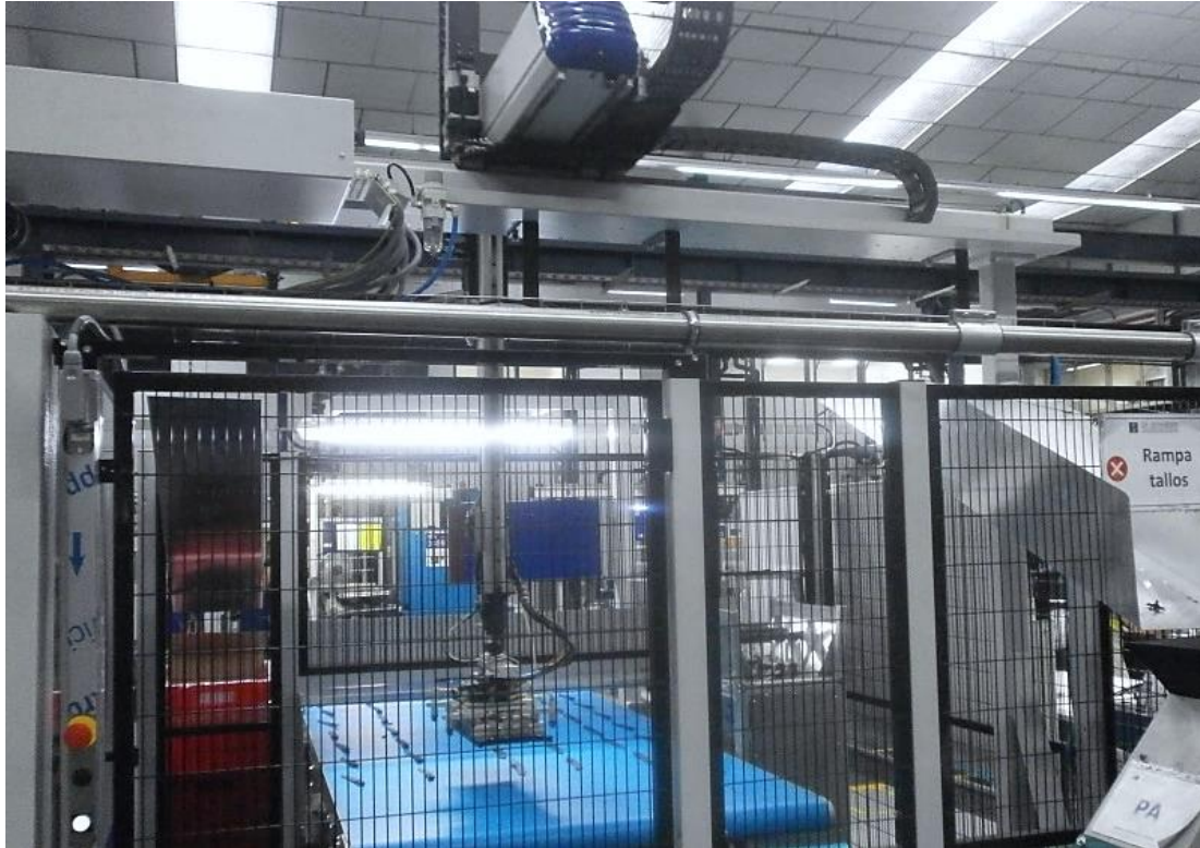
Ilustración 4 – Robot Sepro con aprehensión rompe tallos.
