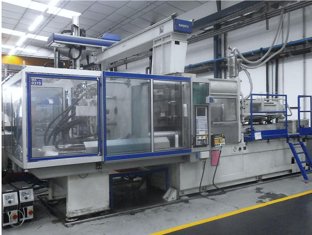
Ilustración 2 – Inyectora Krauss Maffei 450Tn con robot Sepro
