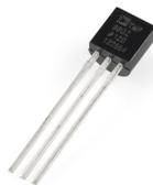
Figura A.3: Sensor de temperatura
