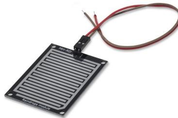
Figura A.4: Sensor de humedad
