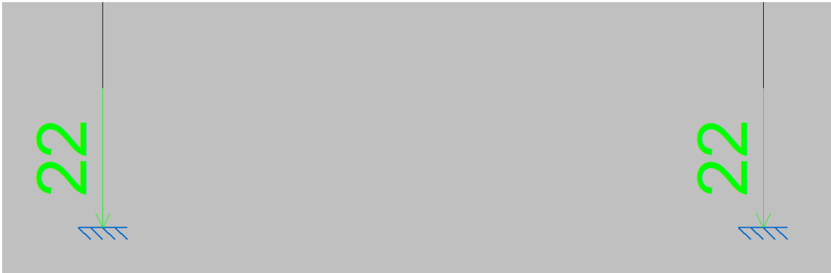
Ilustración 36 – Cargas introducidas en el modelo simulando el peso de la viga de atado longitudinal
