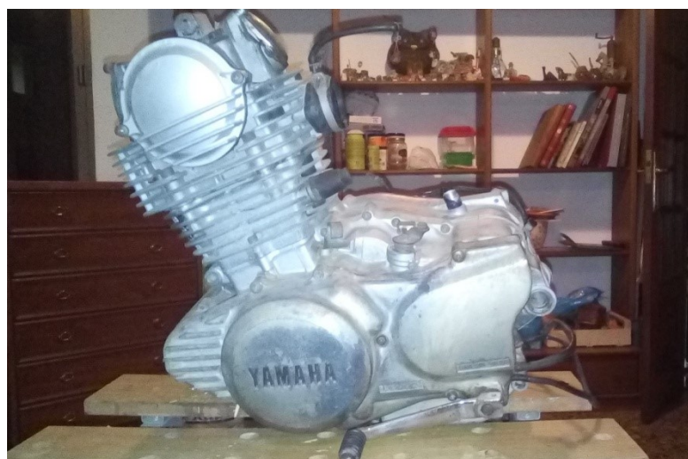
Figura 1. Motor de moto 4 tiempos Otto
