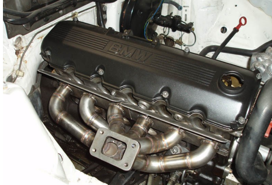
Figura 15. Colector de escape montado en motor.
