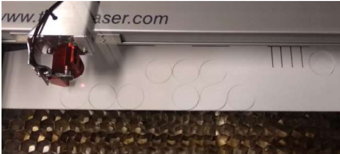
Imagen 209 / Corte láser monedas / Fuente: Elaboración propia
