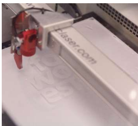
Imagen 193 / Grabado láser marca "Fast Wood Festival"/ Fuente: Elaboración propia
