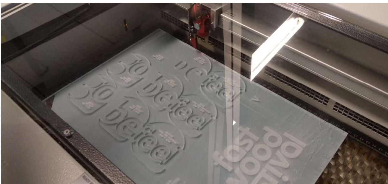
Imagen 212 / Corte y grabado láser medallas en metacrilato transparente / Fuente: Elaboración propia
