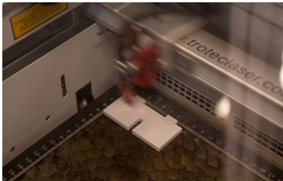
Imagen 150 / Máquina láser grabando el sello en seco / Fuente: Elaboración propia
