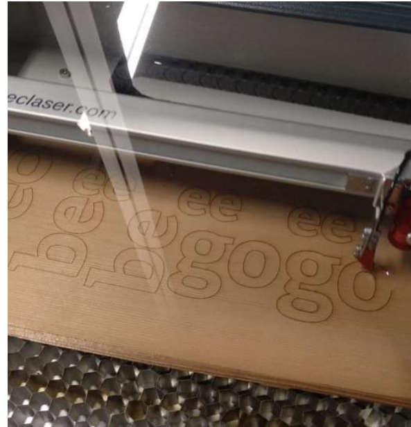
Imagen 211 / Corte láser letras medallas en madera de cedro / Fuente: Elaboración propia
