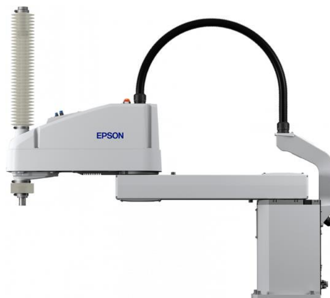
Figura 5.1.- Robot SCARA Epson LS20 (Fuente: www.epson.es ).
