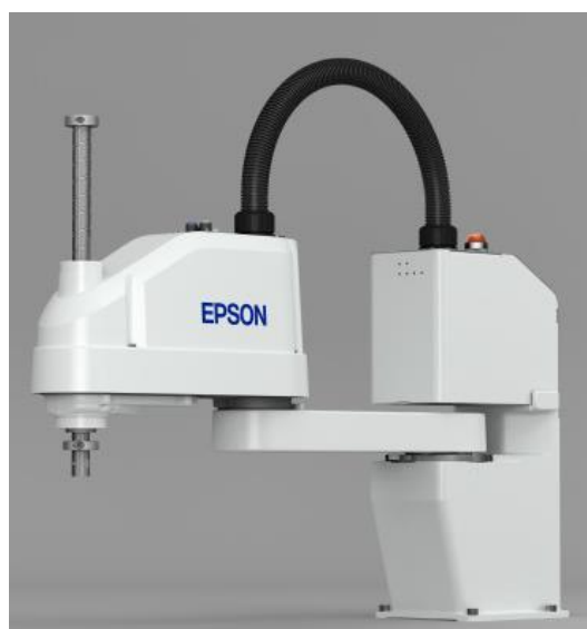
Figura 5.7.- Robot SCARA Epson T6 (Fuente: www.epson.es ).
