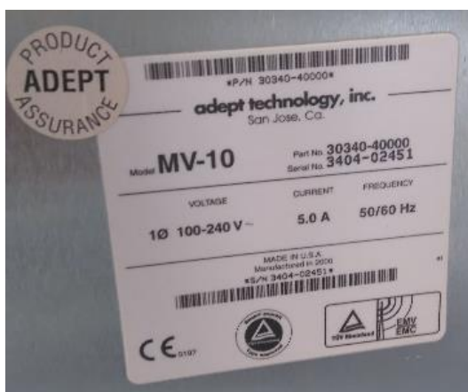
Figura 2.13.- Placa de características del controlador (Fuente: propia).
