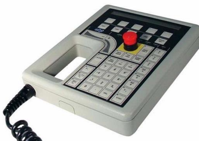
Figura 3.4.- Mando de control manual, MCP (Fuente: propia).
