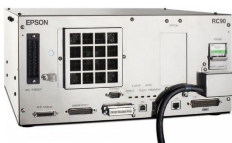
Figura 5.2.- Controlador RC90 para serie LS20 (Fuente: www.epson.es ).
