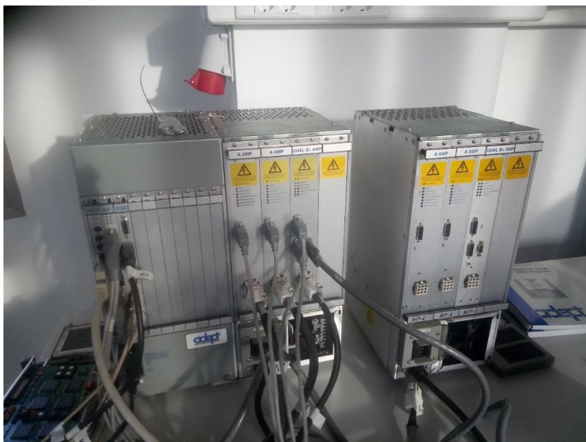
Figura 2.8.- Controlador y chasis de potencia para robot Adept Three XL (Fuente: propia).
