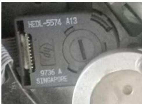
Figura 4.7.- Sensores de las articulaciones 3 y 4 del Adept Three XL (Fuente: propia).
