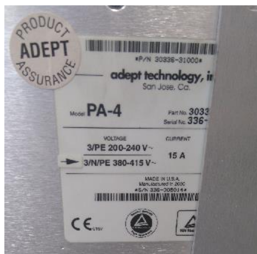
Figura 2.12.- Placa de características del chasis de potencia (Fuente: propia).
