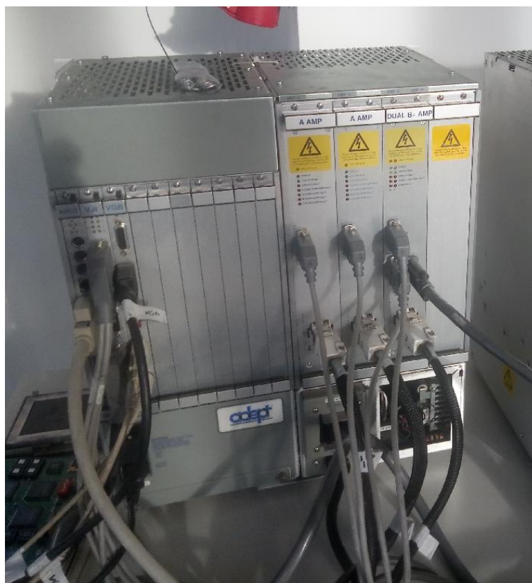
Figura 3.8.- Conexiones a la parte electrónica de control del Adept Three XL (Fuente: propia).
