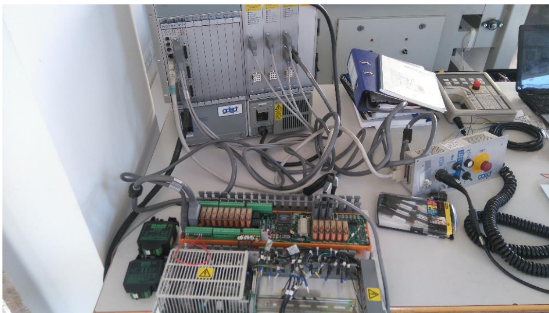
Figura 3.7.- Montaje y cableado realizado para las pruebas del esquema básico 1 (Fuente: propia).
