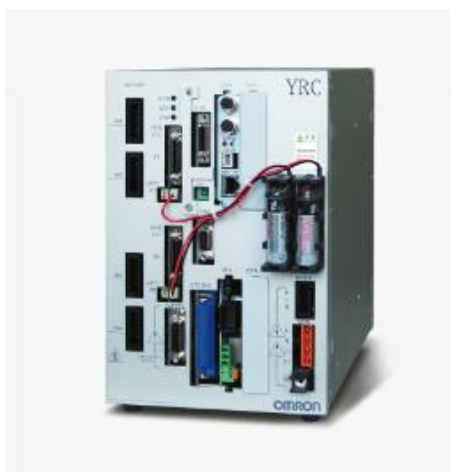
Figura 5.11.- Controlador YRC para robot SCARA Omron serie XGL (Fuente: www.omron.es ).
