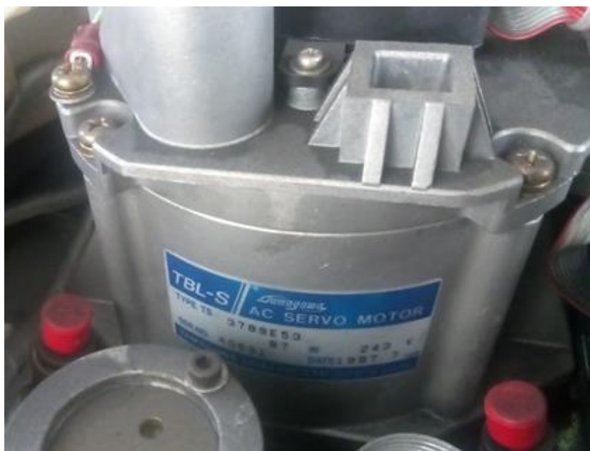
Figura 4.6.- Actuador servomotor articulaciones 3 y 4 del Adept Three XL (Fuente: propia).
