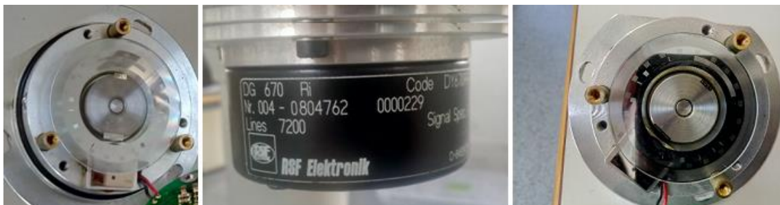
Figura 4.4.- Sensores de las articulaciones 1 y 2 del Adept Three XL (Fuente: propia).
