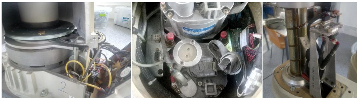
Figura 4.1.- Servomotores Adept Three XL (Fuente: propia).
