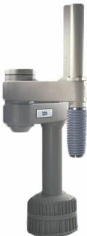
Figura 1.1.- Robot SCARA ( www.adept.com cortesía OMROM).
