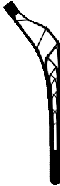
Figura 3.81 Solución para tensión máxima admisible 258.3 MPa
