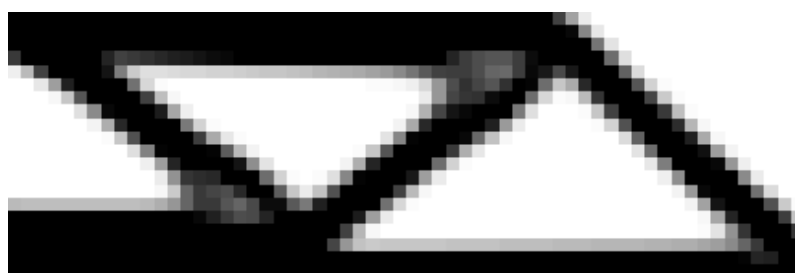
Figura 2.10 Solución viga biapoayada
