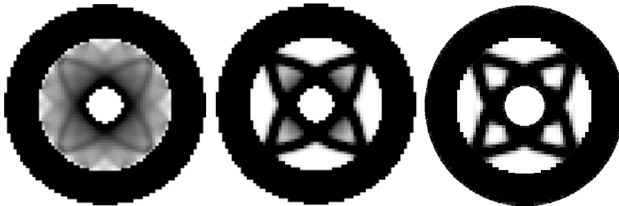
Figura 3.69 Evolución y solución para el tipo de optimización A. Volante de inercia. 3092 elementos activos
