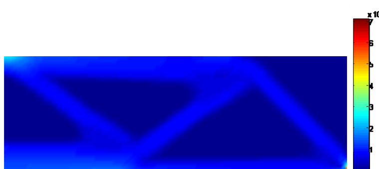
Figura 3.54 Distribución de tensiones en la viga biapoyada
