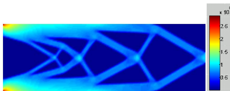
Figura 3.64 Distribución de tensiones de Von Mises. Viga en voladizo.
