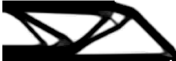
Figura 5.10 Solución final viga biapoyada
