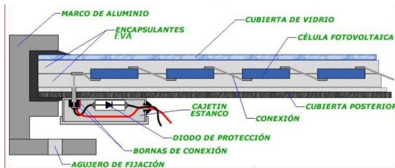
ELEMENTOS DE UN PANEL FOTOVOLTAICO
