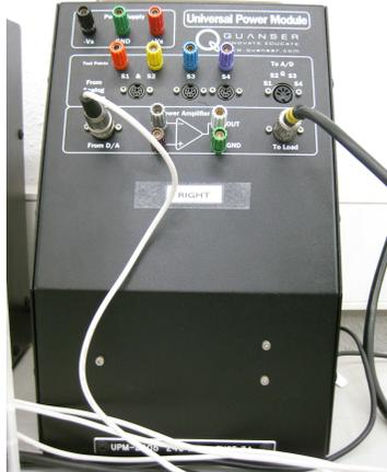
Figura 60: Amplificador de potencia(4 uds)
