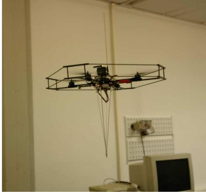
Figura 47: Vuelo semi autónomo del mini helicóptero en 3D.
