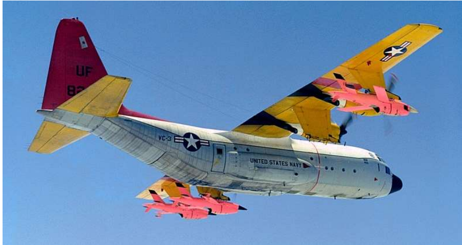
Figura 4. DC-130 de la U.S. Navy preparado para el lanzamiento de drones FireBee
